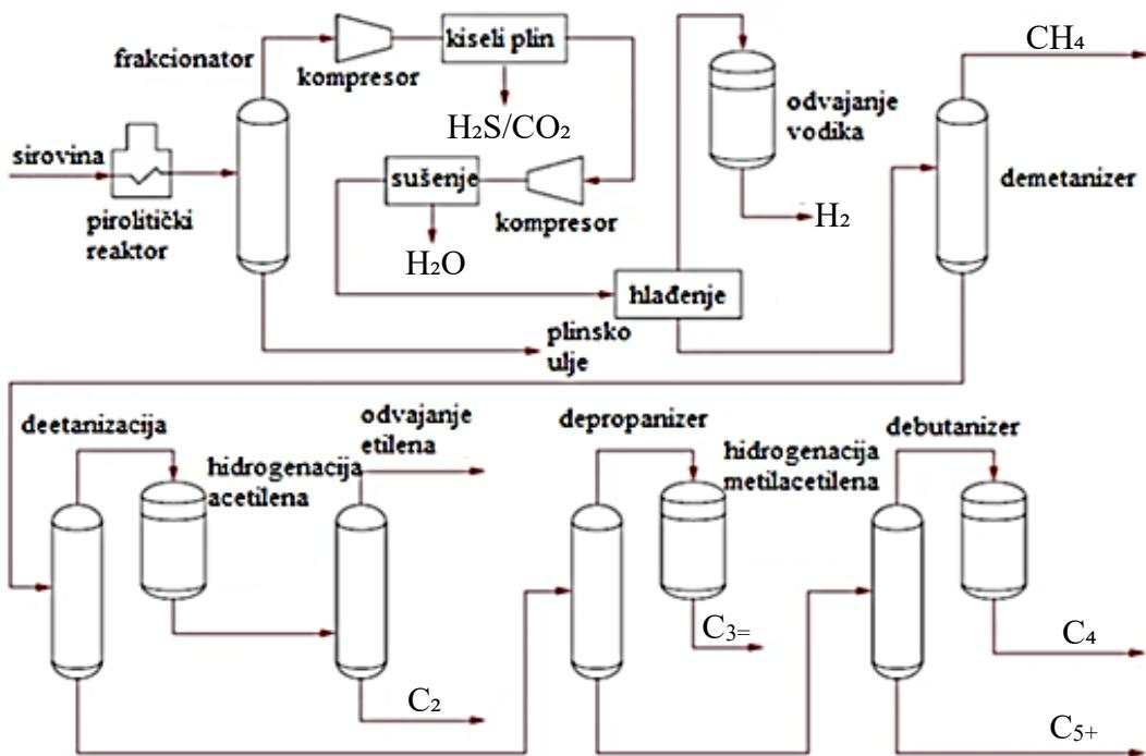
*Slika 7. Shematski prikaz parnog kreiranja i odvajanja produkata<sup>12</sup>*
