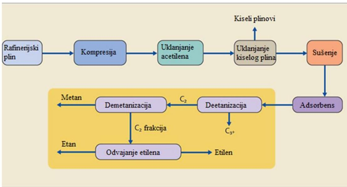
**Slika 8.** Proces obrade i separacije rafinerijskog plina<sup>16</sup>
