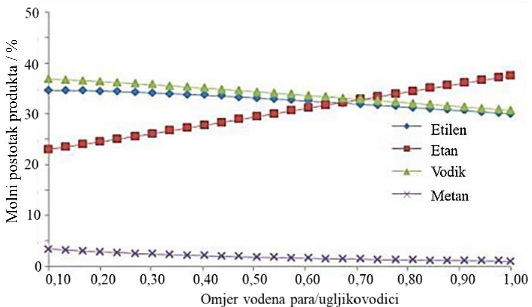
*Slika 6. Ovisnost sastava produkta o omjeru vodene pare i ugljikovodika<sup>11</sup>*
