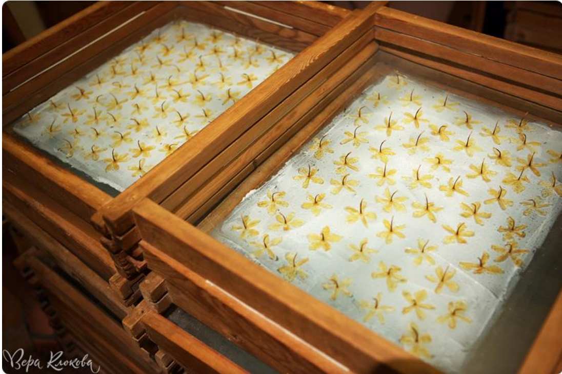
Slika 8. Prikaz ekstrakcije eteričnih ulja iz latica pomoću masti.
