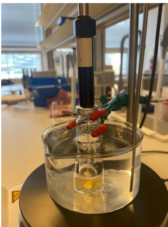
Slika 9. Aparatura za mikroekstrakciju vršnih para na krutoj fazi
