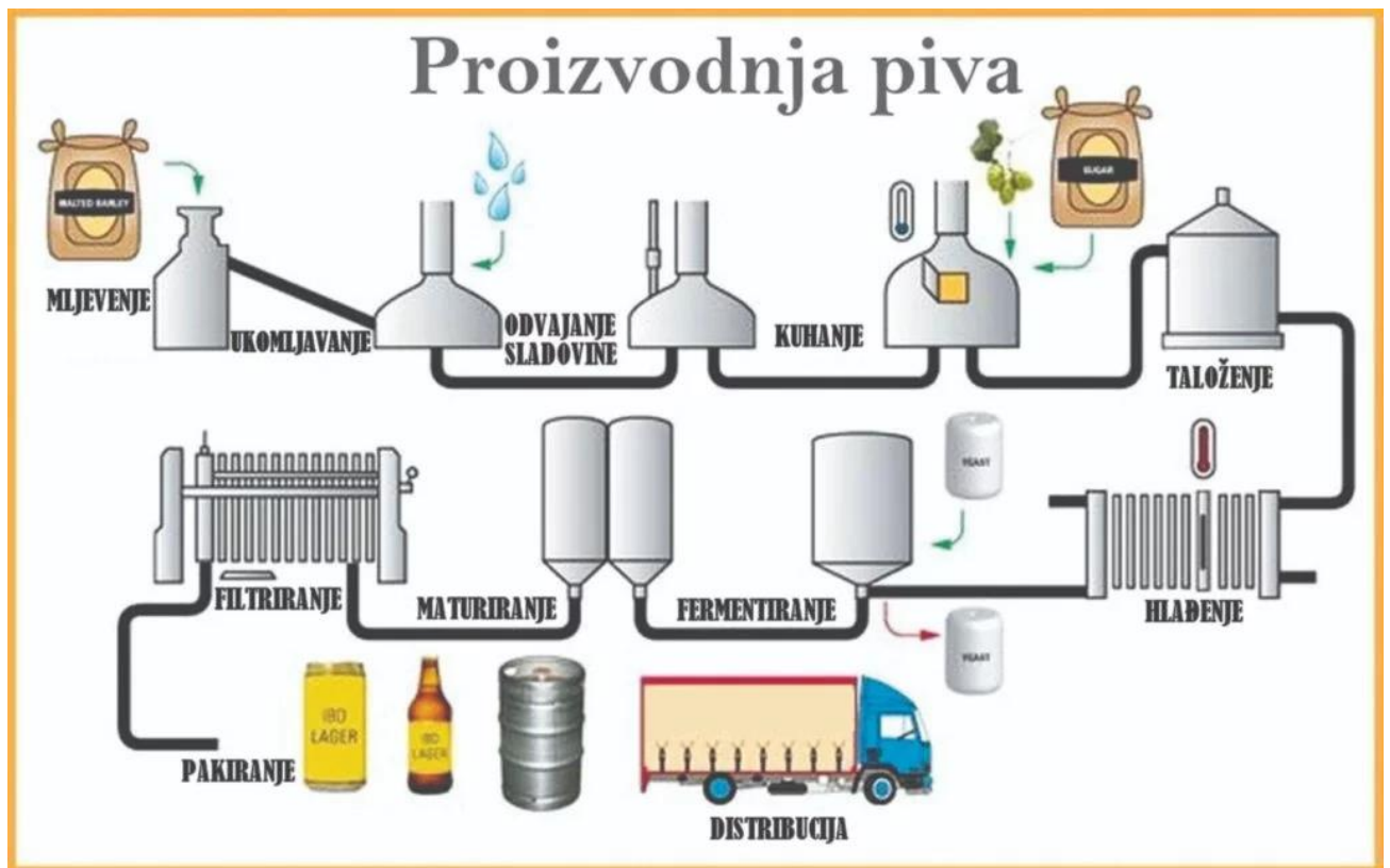
Slika 1. Tehnološka shema proizvodnje piva 9
