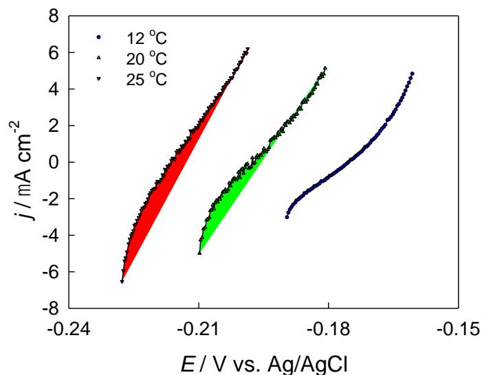
**Slika 20.** Linearne polarizacijske krivulje elektrode od Cu10Ni legure u 3,5 %-tnoj NaCl otopini, pH 8 pri različitim temperaturama elektrolita ( $12 \text{ }^{\circ}\text{C}$ ,  $20 \text{ }^{\circ}\text{C}$  i  $25 \text{ }^{\circ}\text{C}$ ) snimljene brzinom promjene potencijala od  $0,3 \text{ mV s}^{-1}$  – nezaštićena elektroda
