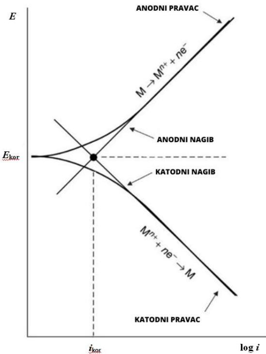
**Slika 12.** Određivanje korozijskih parametara metodom ekstrapolacije Tafelovih pravaca<sup>9</sup>
