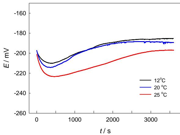
**Slika 18.** Ovisnost potencijala otvorenog strujnog kruga o vremenu za elektrodu od Cu10Ni legure uz dodatak ekstrakata duhana u 3,5 %-tnoj NaCl otopini, pH 8 pri različitim temperaturama elektrolita ( $12^{\circ}\text{C}$ ,  $20^{\circ}\text{C}$  i  $25^{\circ}\text{C}$ )
