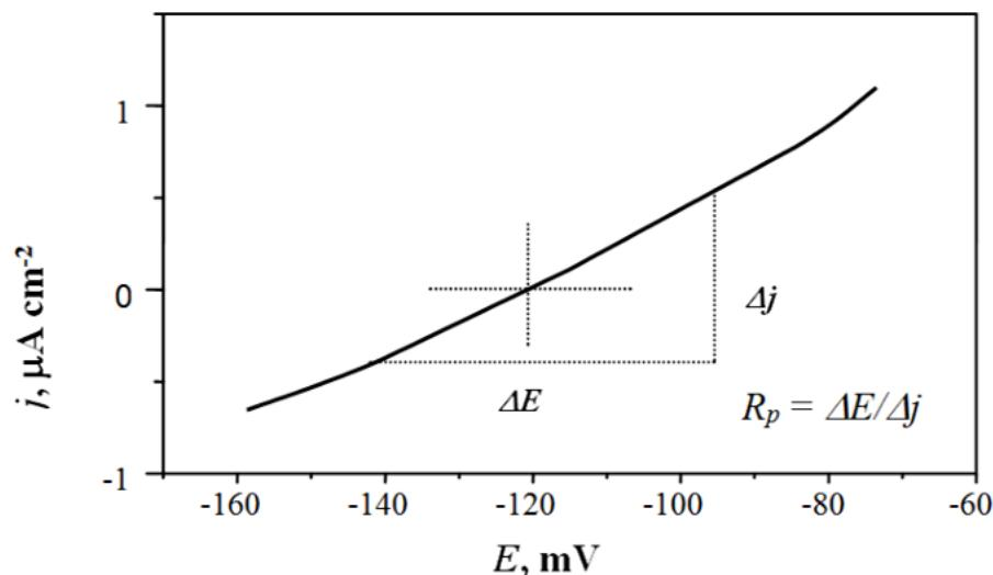
**Slika 8.** Određivanje polarizacijskog otpora metodom linearne polarizacije<sup>9</sup>
