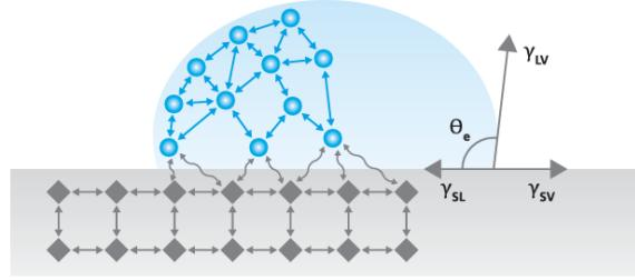
**Slika 14.** Prikaz trofazne kontaktne točke<sup>56</sup>
