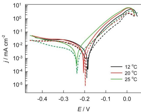
**Slika 26.** Tafelov prikaz polarizacijskih krivulja za elektrodu od Cu10Ni legure u 3,5 %-tnoj NaCl otopini, pH 8 pri različitim temperaturama elektrolita (12 °C, 20 °C i 25 °C): bez (pune linije) i uz dodatak ekstrakta ostataka duhana (isprekidane linije)
