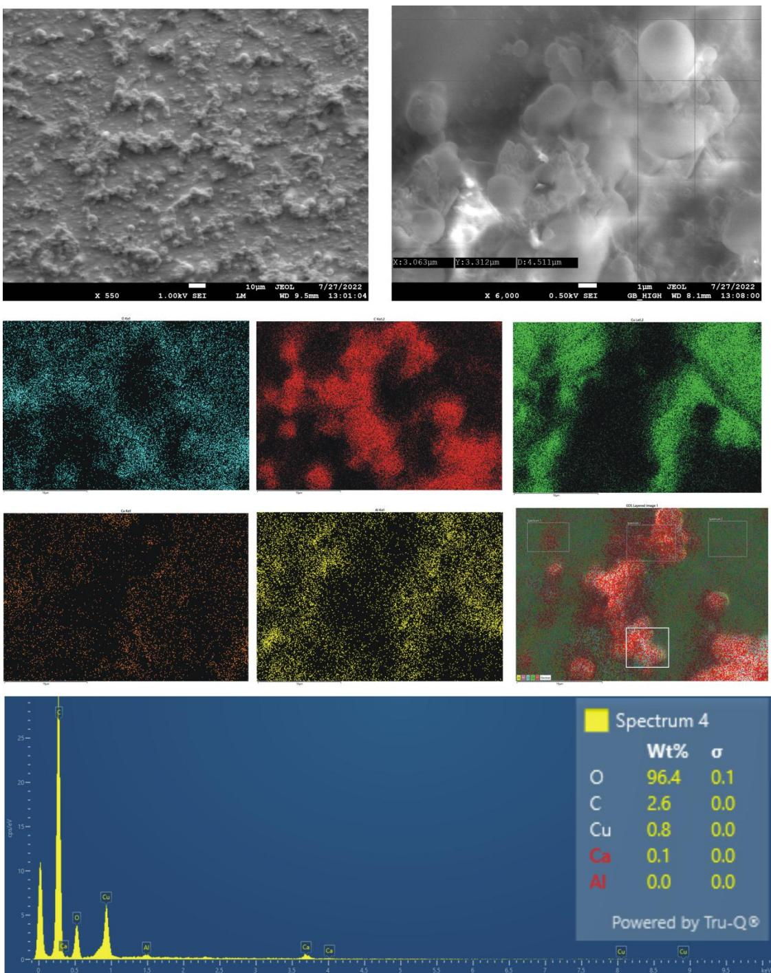
**Slika 30.** SEM slika s  $\times 550$  (1 kV SEI) i s  $\times 6000$  povećanjem (0.5 keV SEI) površine pločice od Cu10Ni legure na koju je nanesen ekstrakt filtera (gore) i elementarno mapiranje položaja 4. površine (u sredini). EDS dijagram za pločicu od Cu10Ni legure na koju je nanesen ekstrakt filtera (dolje)
