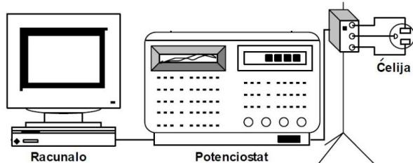
**Slika 15.** Prikaz aparature za provedbu elektrokemijskih ispitivanja<sup>48</sup>
