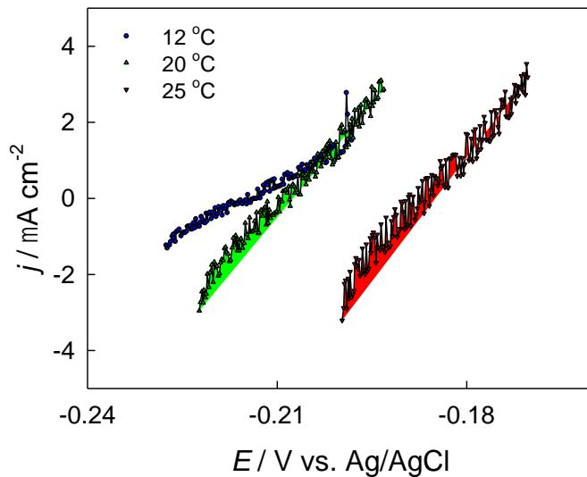
**Slika 21.** Linearne polarizacijske krivulje elektrode od Cu10Ni legure uz dodatak ekstrakta ostataka duhana u 3,5 %-tnoj NaCl otopini, pH 8 pri različitim temperaturama elektrolita ( $12\text{ }^{\circ}\text{C}$ ,  $20\text{ }^{\circ}\text{C}$  i  $25\text{ }^{\circ}\text{C}$ ) snimljene brzinom promjene potencijala od  $0,3\text{ mV s}^{-1}$
