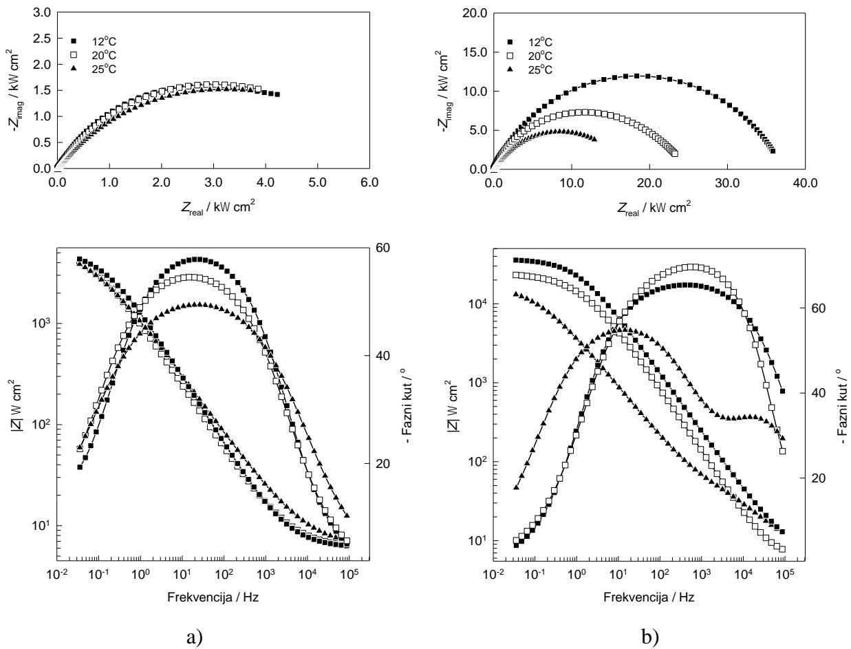
**Slika 25.** Nyquistov i Bodeov prikaz impedancijskih spektara za elektrodu od Cu10Ni legure uz dodatak ekstrakta ostataka duhana (a) i uz dodatak ekstrakta filtera (b) u 3,5 %-tnoj NaCl otopini, pH 8 pri različitim temperaturama elektrolita (12 °C, 20 °C i 25 °C), na potencijalu otvorenog strujnog kruga ( $E_{\text{ok}}$ )
