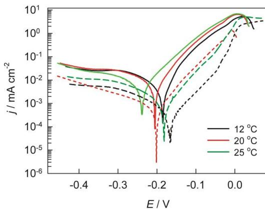
**Slika 27.** Tafelov prikaz polarizacijskih krivulja za elektrodu od Cu10Ni legure u 3,5 %-tnoj NaCl otopini, pH 8 pri različitim temperaturama elektrolita (12 °C, 20 °C i 25 °C): bez (pune linije) i uz dodatak ekstrakta filtera (isprekidane linije)
