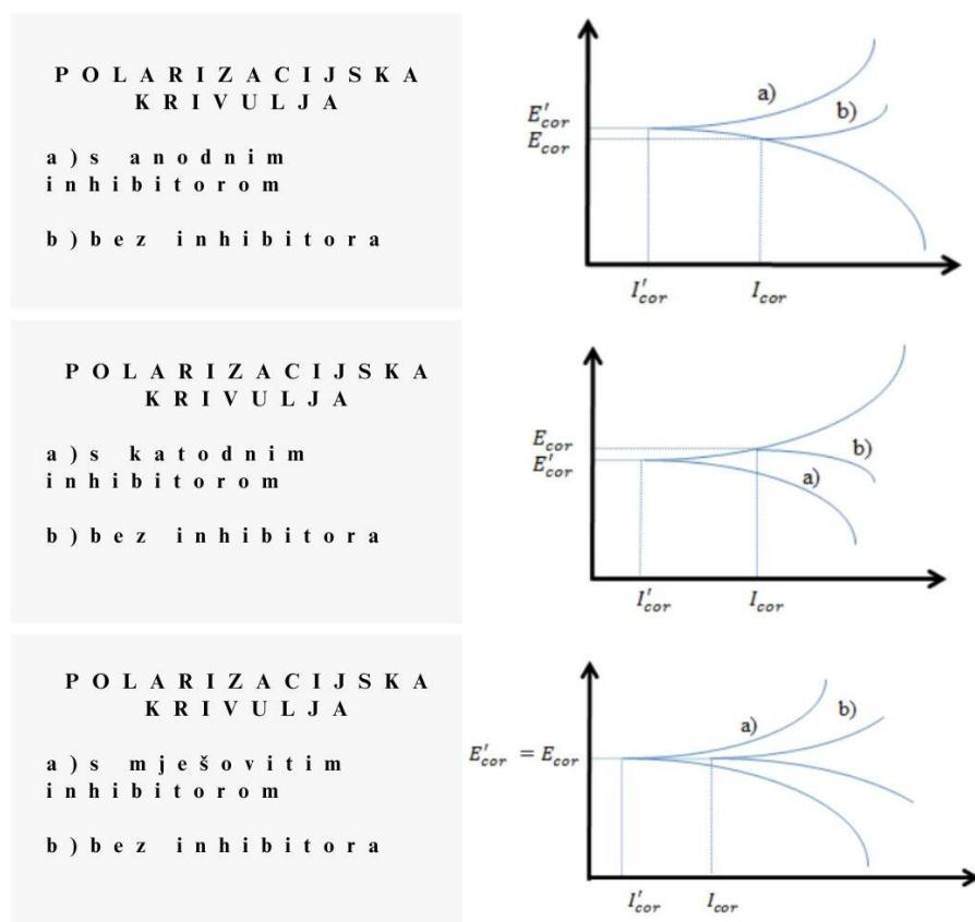
**Slika 5.** Prikaz polarizacijskih krivulja za metal: bez inhibitora i s inhibitorom: (odozgo prema dolje) anodnim, katodnim i mješovitim<sup>28</sup>
