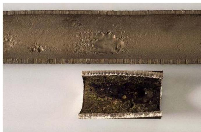
Slika 4. Erozija korozija CuNi legure<sup>25</sup>
