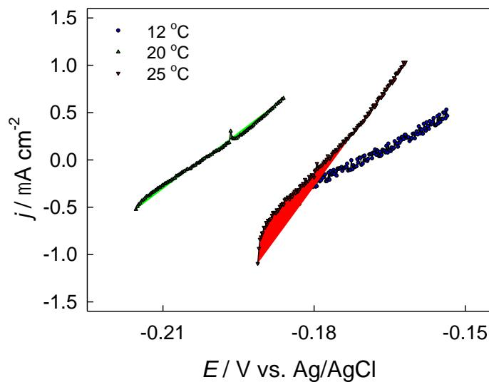
**Slika 22.** Linearne polarizacijske krivulje elektrode od Cu10Ni legure uz dodatak ekstrakta filtera u 3,5 %-tnoj NaCl otopini, pH 8 pri različitim temperaturama elektrolita ( $12\text{ }^{\circ}\text{C}$ ,  $20\text{ }^{\circ}\text{C}$  i  $25\text{ }^{\circ}\text{C}$ ) snimljene brzinom promjene potencijala od  $0,3\text{ mV}^{-1}$
