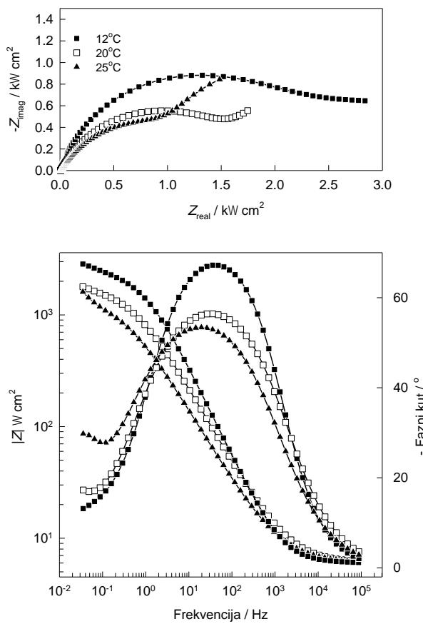
**Slika 24.** Nyquistov i Bodeov prikaz impedancijskog spektra elektrode od Cu10Ni legure u 3,5 %-tnoj NaCl otopini, pH 8 pri različitim temperaturama elektrolita (12 °C, 20 °C i 25 °C), na potencijalu otvorenog strujnog kruga ( $E_{\text{ok}}$ ) – nezaštićena elektroda
