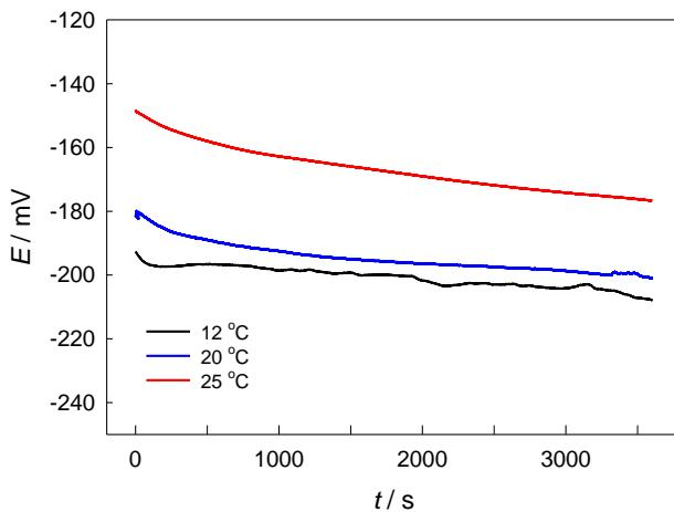
**Slika 19.** Ovisnost potencijala otvorenog strujnog kruga o vremenu za elektrodu od Cu10Ni legure uz dodatak ekstrakta filtera u 3,5 %-tnoj NaCl otopini, pH 8 pri različitim temperaturama elektrolita (12 °C, 20 °C i 25 °C)
