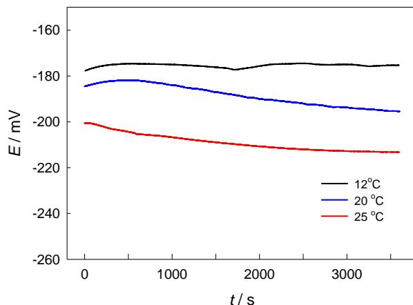
**Slika 17.** Ovisnost potencijala otvorenog strujnog kruga o vremenu za elektrodu od Cu10Ni legure u 3,5 %-tnoj NaCl otopini, pH 8 pri različitim temperaturama elektrolita ( $12^{\circ}\text{C}$ ,  $20^{\circ}\text{C}$  i  $25^{\circ}\text{C}$ ) – nezaštićena elektroda
