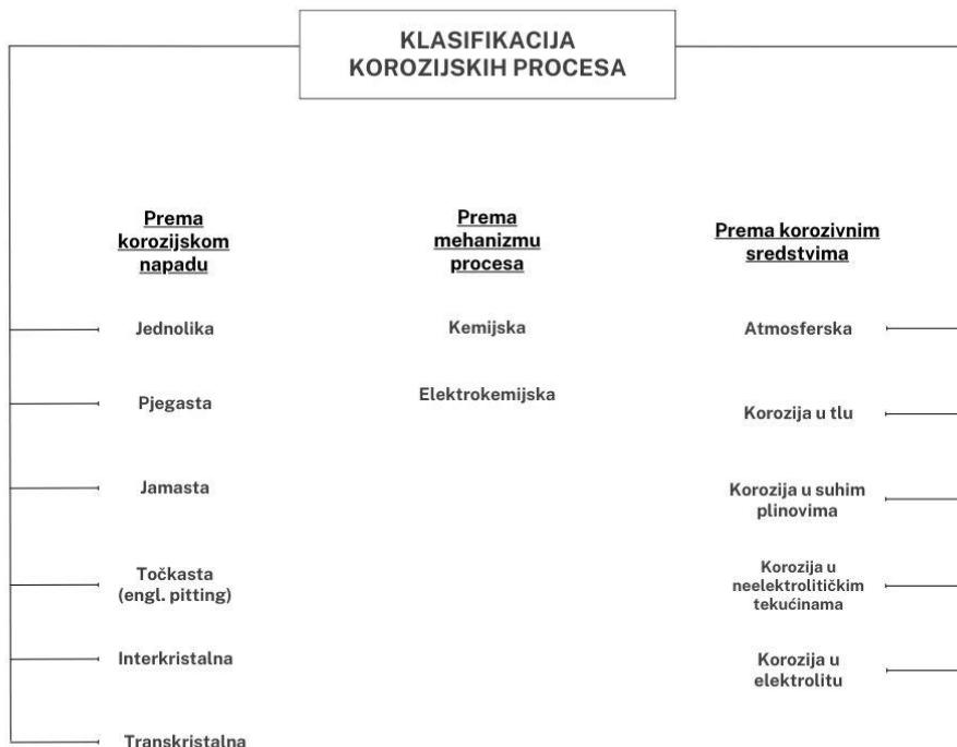
**Slika 3. Klasifikacija korozijskih procesa<sup>10</sup>**
