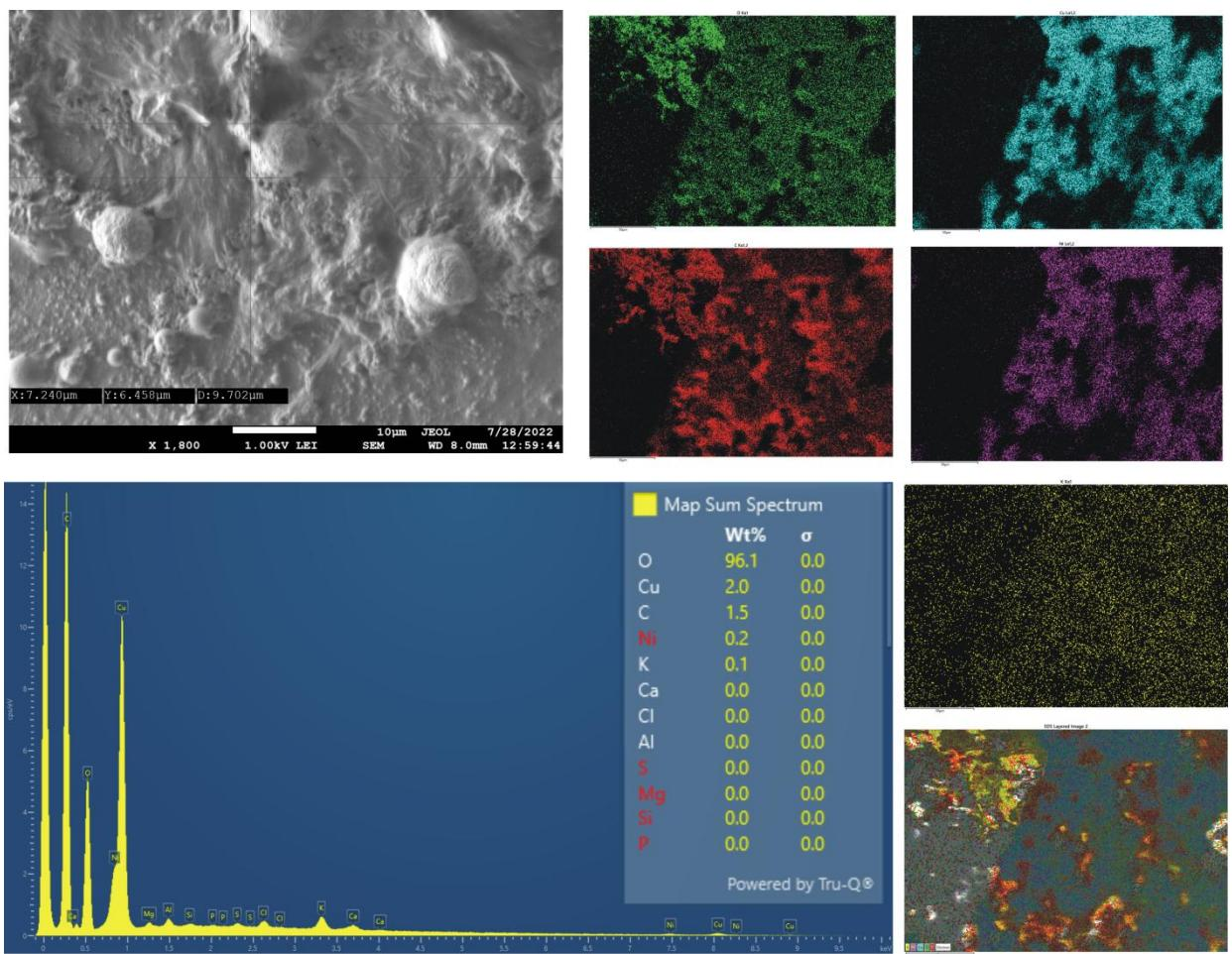
**Slika 29.** SEM slika s  $\times 1800$  povećanjem (1,0 kV LEI) pločice od Cu10Ni legure na koju je nanesen ekstrakt ostataka duhana (gore lijevo) i elementarno mapiranje površine (u sredini). EDS dijagram za pločicu od Cu10Ni legure na koju je nanesen ekstrakt ostataka duhana (dolje)
