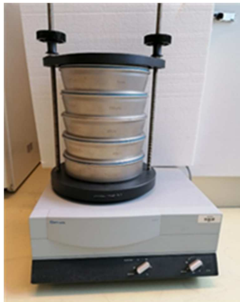
Slika 2.3. Laboratorijski uređaj za prosijavanje "Retsch AS200 basic"
