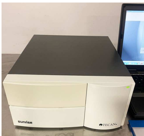
Slika 15. Mikrotitarski čitač absorbancije 34
