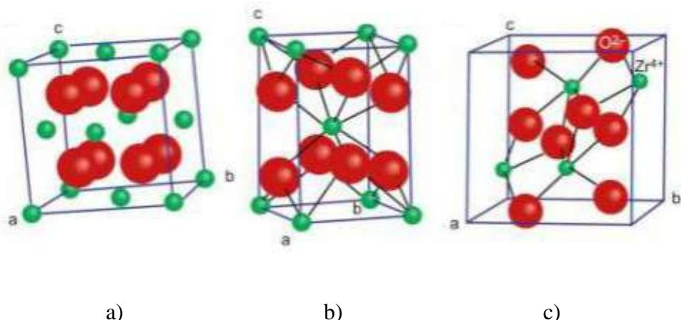
Slika 7. Izgled kristalnih modifikacija  $ZrO_2$ , a) kubična, b) tetragonska i c) monoklinska kristalna rešetka<sup>13</sup>
