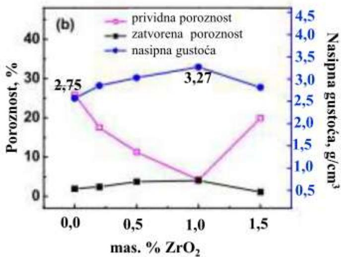
Slika 12. Ovisnost nasipne gustoće i poroznosti o dodatku  $\text{ZrO}_2$  pri procesu sinteriranja  $\text{MgO}$  dobivenom iz prirodnih slanih voda<sup>18</sup>
