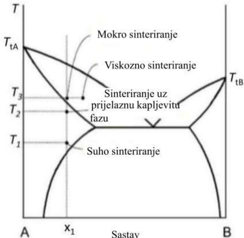
Slika 6. Dijagram sinteriranja u čvrstom i kapljevitom stanju<sup>6</sup>
