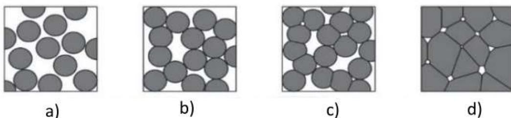
Slika 5. Prikaz strukturalnih promjena tijekom odgovarajućih faza procesa sinteriranja<sup>10</sup>
