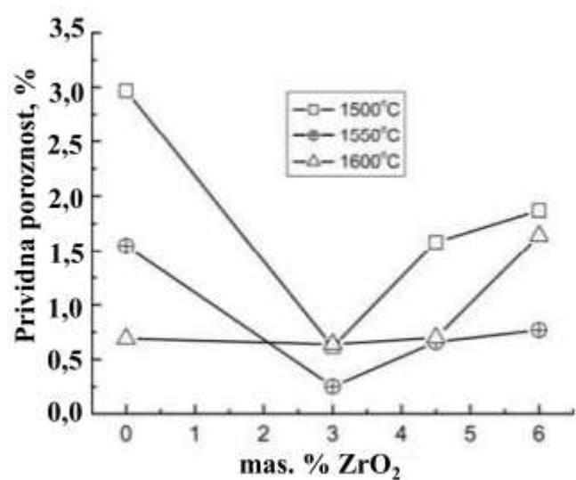
Slika 13. Ovisnost prividne poroznosti sinteriranih uzoraka o količini dodanog  $\text{ZrO}_2$  pri različitim temperaturama sinteriranja<sup>19</sup>
