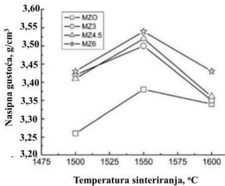
Slika 14. Ovisnost nasipne gustoće sinteriranih uzoraka o temperaturi sinteriranja za različite količine dodanog  $\text{ZrO}_2$  (0%, 3%, 4,5% i 6%)<sup>19</sup>
