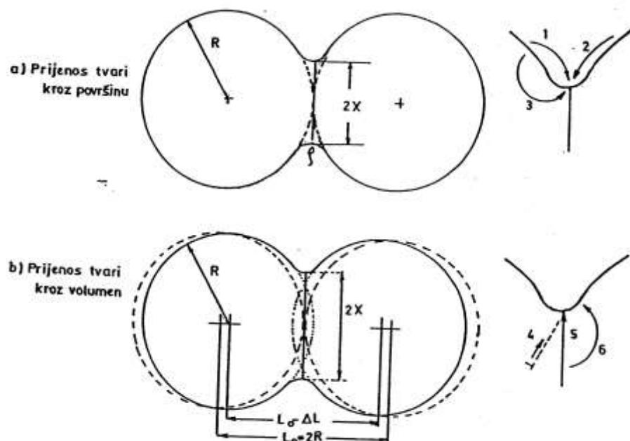
Slika 4. Mehanizmi prijenosa mase pri sinteriranju<sup>10</sup>
