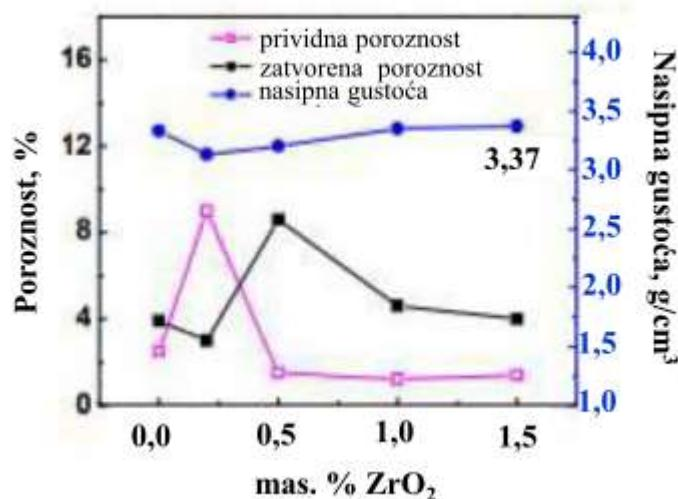
Slika 10. Ovisnost nasipne gustoće i poroznosti o dodatku ZrO<sub>2</sub> pri procesu sinteriranja MgO dobivenom iz MgCl<sub>2</sub>·6H<sub>2</sub>Op.a.<sup>18</sup>
