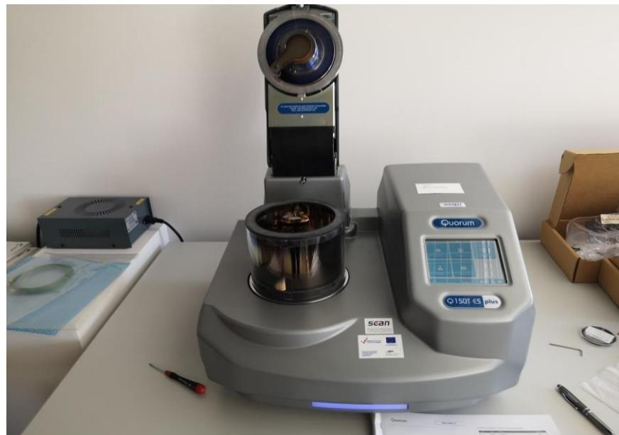
**Slika 14.** QUORUM – Q150T ES plus- uređaj koji služi za nanošenje sloja zlata prije provođenja SEM-a, u slučaju da se radi o materijalu koji je izolator. Optimiziran je za korištenje s turbomolekularnom pumpom koja daje niži vakuum do  $5 \times 10^5$  mbar. To omogućuje raspršivanje oksidirajućih metala.<sup>19</sup>
