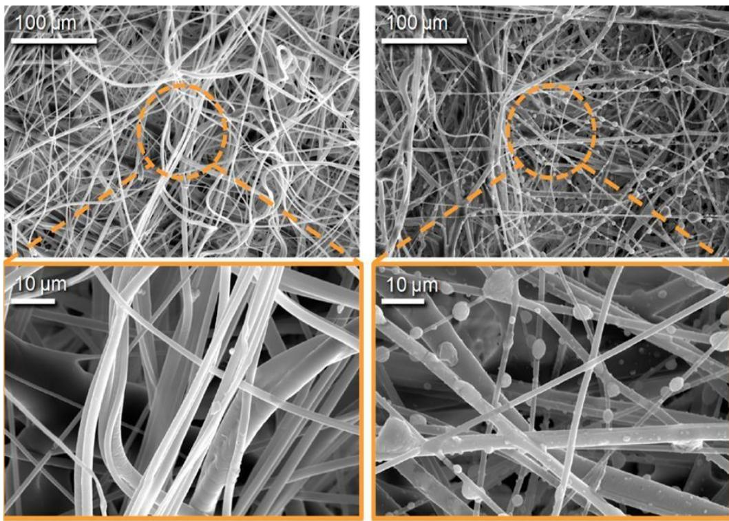
**Slika 4.** Prikaz filtera pod elektronskim mikroskopom sa NSS česticama i bez. Slike s lijeve strane prikazuju filtre bez NSS čestica koji imaju glatku površinu vlakana dok slike s desne strane prikazuju filtre sa NSS česticama na vlaknima čija je površina neravna, eliptična i šarolika.<sup>17</sup>
