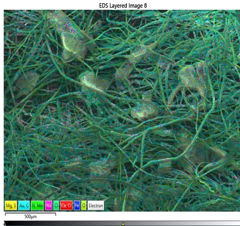
Slika 27. Prikaz rezultata mapiranja kemijskih elemenata za morsku (krupnu) sol.
