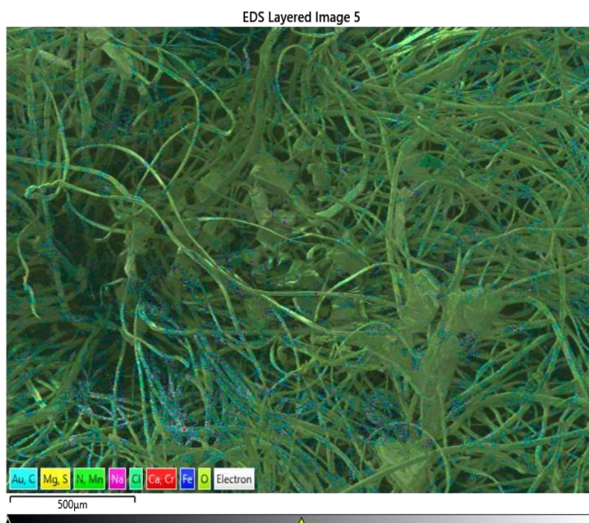
Slika 51. Prikaz rezultata mapiranja kemijskih elemenata za himalajske soli (40g soli u 100ml vode).
