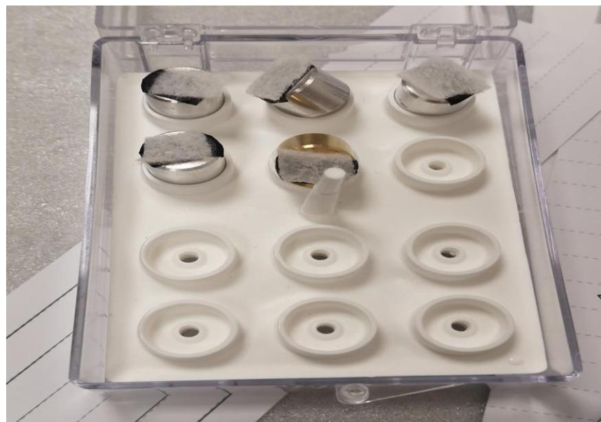
**Slika 9.** Priprema uzoraka za SEM.
