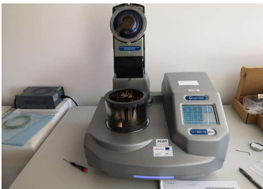
Slika 14. QUORUM – Q150T ES plus- uređaj koji služi za nanošenje sloja zlata prije provođenja SEM-a, u slučaju da se radi o materijalu koji je izolator. Optimiziran je za korištenje s turbomolekularnom pumpom koja daje niži vakuum do 5 \times 10^5 mbar. To omogućuje raspršivanje oksidirajućih metala. 19
