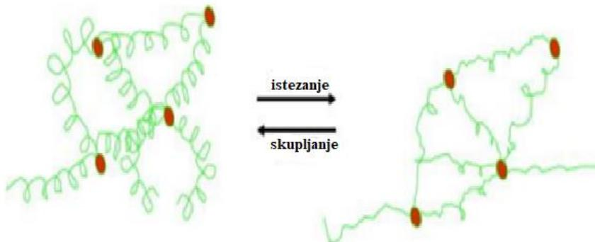
Slika 10. Prikaz rastezanja elastomera i vraćanje u prvobitno stanje<sup>18</sup>
