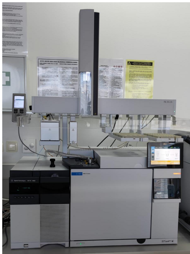
Slika 10. Prikaz plinske kromatografije sa spektrometrijom masa.
