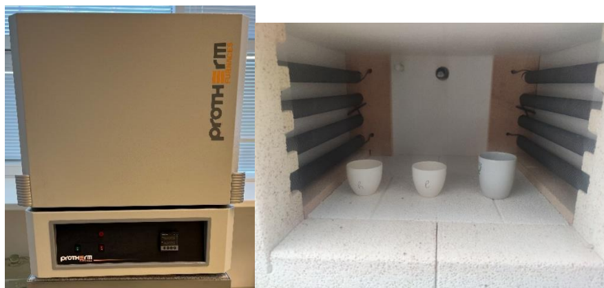
Slika 13. Protherm furnaces PLF 160/5 peć za žarenje
