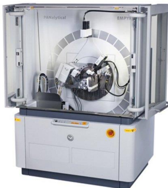
Slika 14. Uređaj za mjerenje difrakcije zraka na polikristalnim uzorcima, Empyrean, Malvern Panalytical
