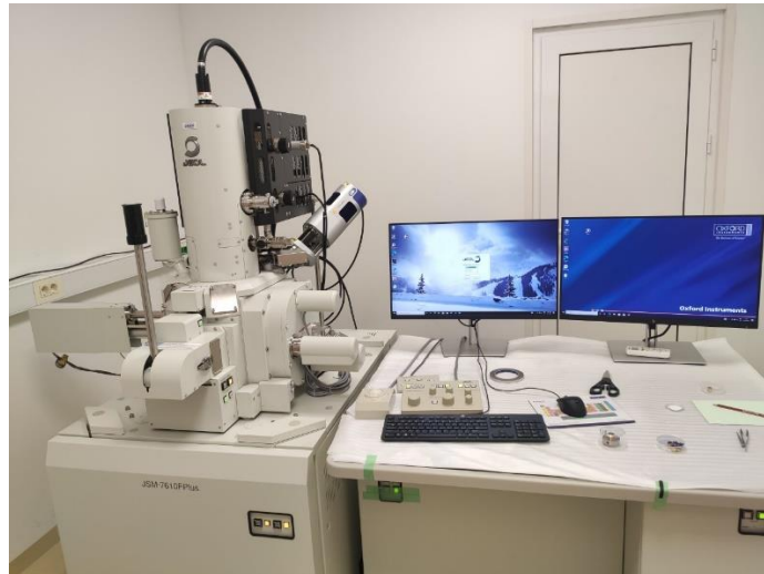
Slika 18. Jeol JEM -7610F Plus pretražni elektronski mikroskop
