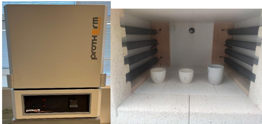
Slika 13. Protherm furnaces PLF 160/5 peć za žarenje
