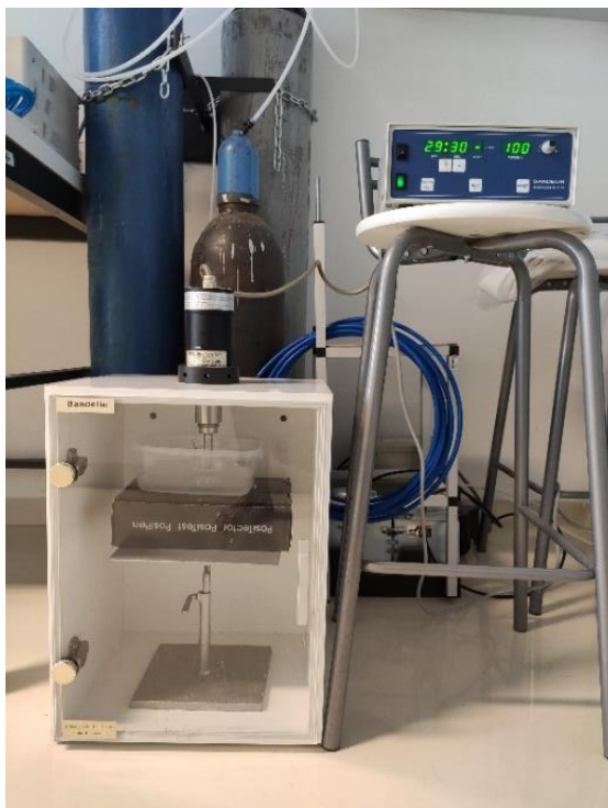
Slika 16. Ultrazvučna sonda (Ultrasonic homogeniser, Bandelin HD 2200, 20 kHz, 200 W)
