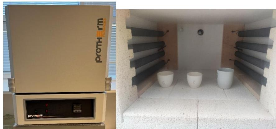
**Slika 13.** Protherm furnaces PLF 160/5 peć za žarenje
