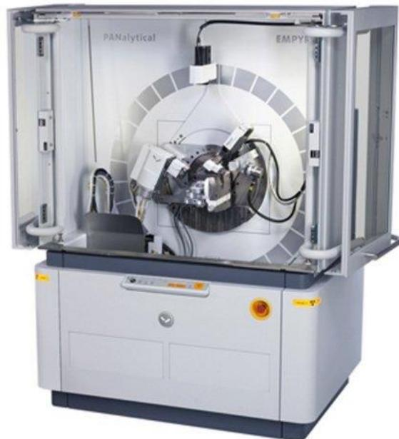
**Slika 14.** Uredaj za mjerjenje difrakcije zraka na polikristalnim uzorcima, Empyrean, Malvern Panalytical
