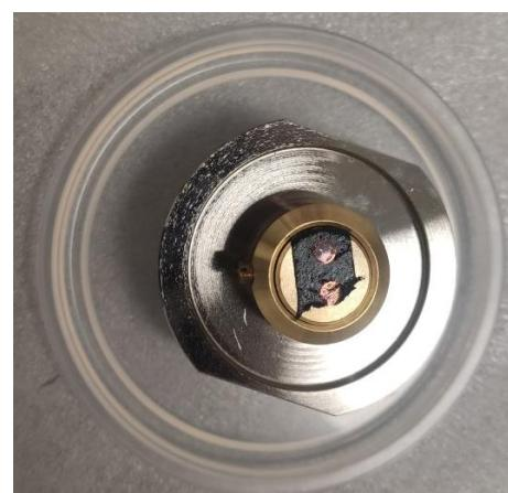
**Slika 19.** Nosač uzorka za snimanje na SEM-u
