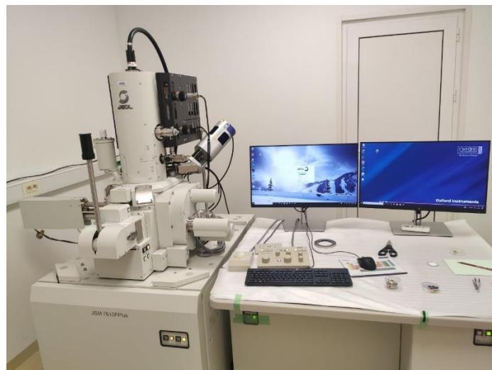
**Slika 18.** Jeol JEM -7610F Plus pretražni elektronski mikroskop
