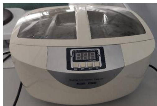
**Slika 21.** Ultrazvučna kupelj, Digital Ultrasonic Cleaner (35 kHz, 60 W)
