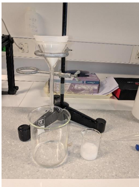
Slika 19. Filtracija nastalog taloga
