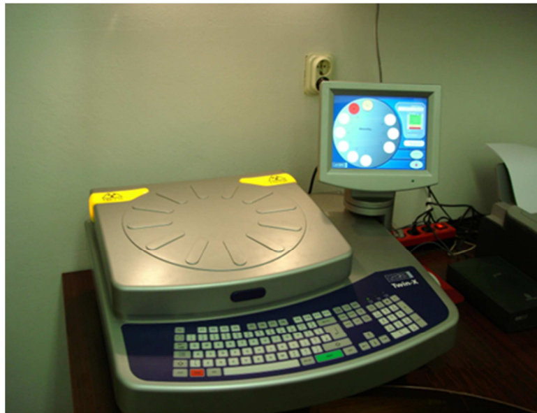
Slika 5. EDXRF uređaj, model Twin-X s tipkovnicom i ekranom vlastitog računala.
