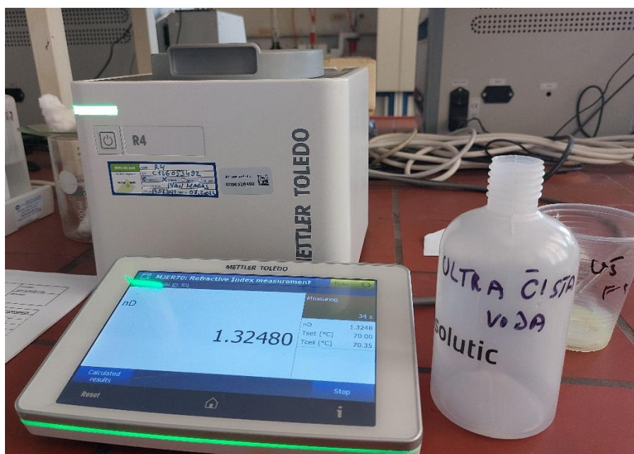
Slika 26. Automatski digitalni refraktometar za mjerenje indeksa refrakcije
