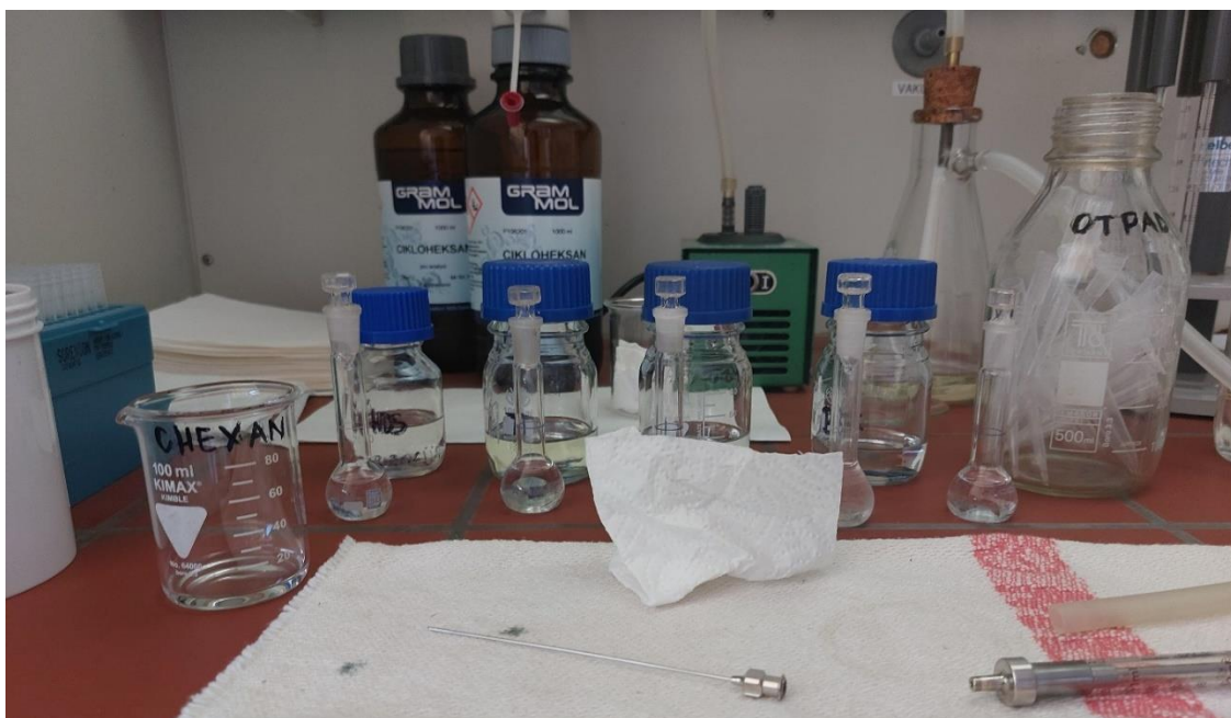
Slika 42. Potrebni pribor za pripremu standardnih otopina i otopina uzoraka
