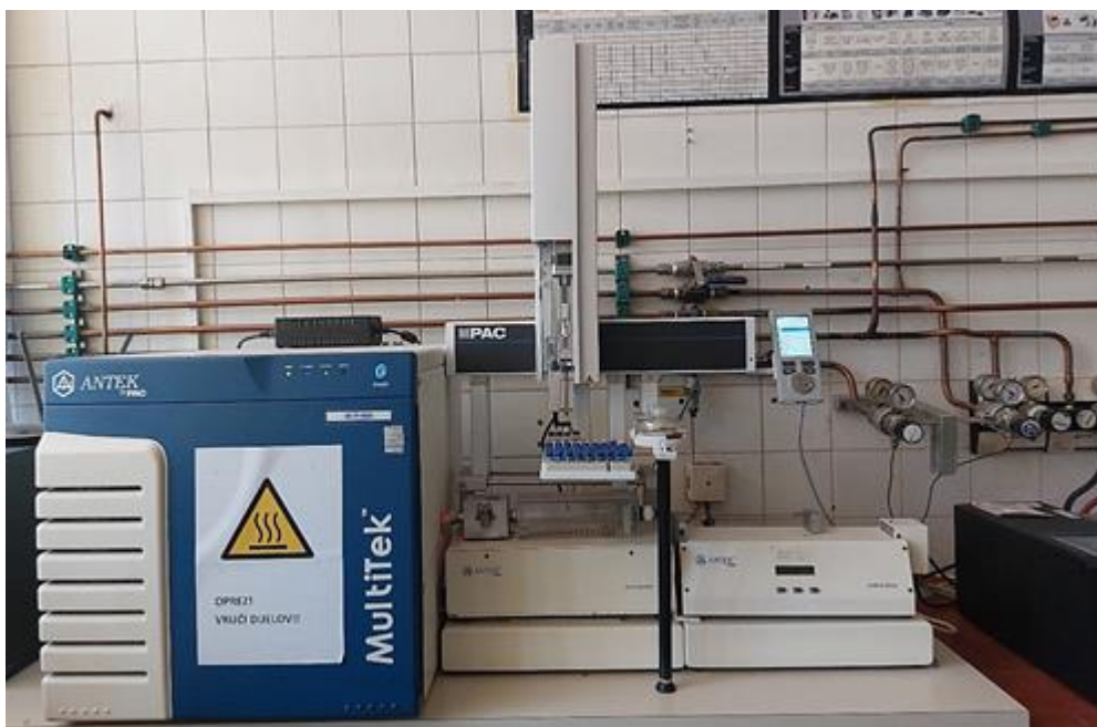
Slika 30. Aparatura za analizu količine dušika sirovine FCC-a i FCC benzina
