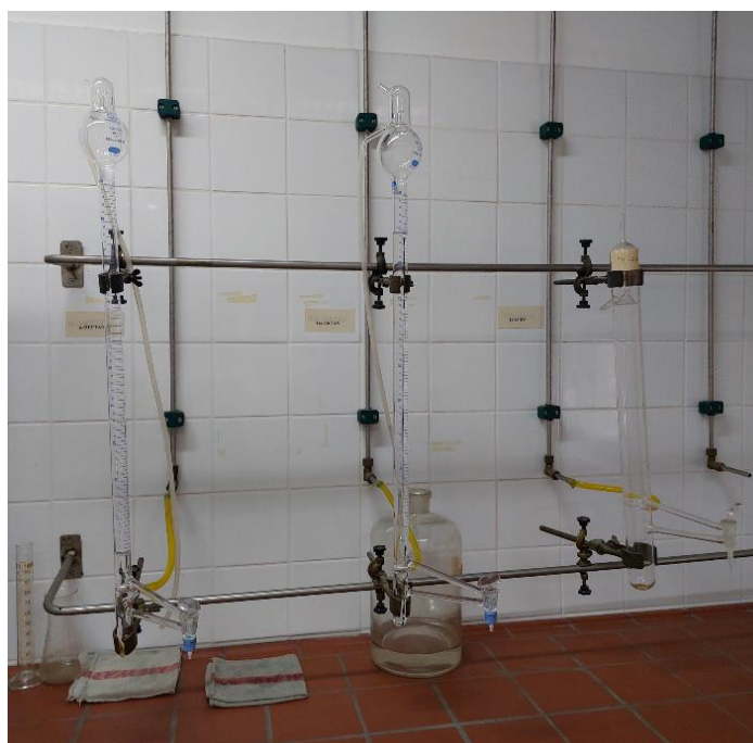
Slika 45. Priprava standardnih smjesa referentnog goriva
