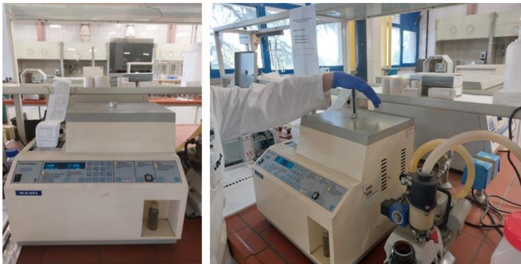
Slika 38. Termostatirana komora za određivanje tlaka pare uzorka
