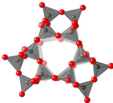
Slika 1.3. Primarne strukturne jedinice  $\text{SiO}_4$  ili  $\text{AlO}_4$  tetraedri u kristalnoj rešetci zeolita (crvena boja predstavlja atom kisika, a siva silicij ili aluminij).<sup>19</sup>
