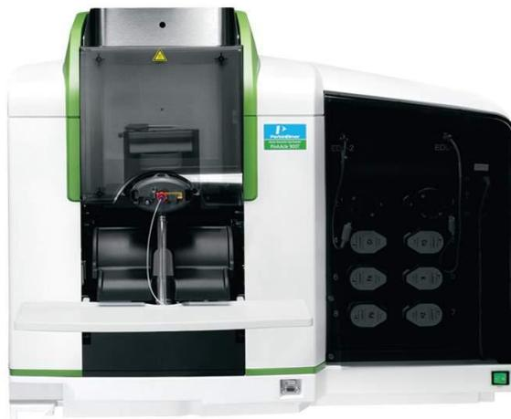
Slika 2.7. Atomski apsorpcijski spektrometar Perkin Elmer PinAAcle 900F AAS.<sup>28</sup>
