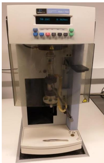
Slika 22. Aparatura za termogravimetrijsku analizu Perkin-Elmer Pyris 1 TGA
