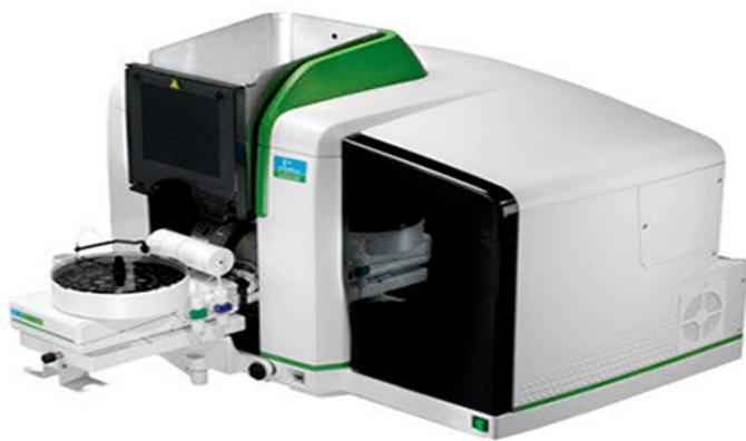
**Slika 2.8.** Atomski apsorpcijski spektrometar Perkin Elmer PinAAcle 900F AAS.
