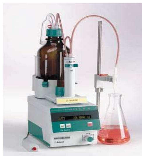
Slika 2.1. Uređaj: Automatski titrator "Metrohm 775 Dosimat".
