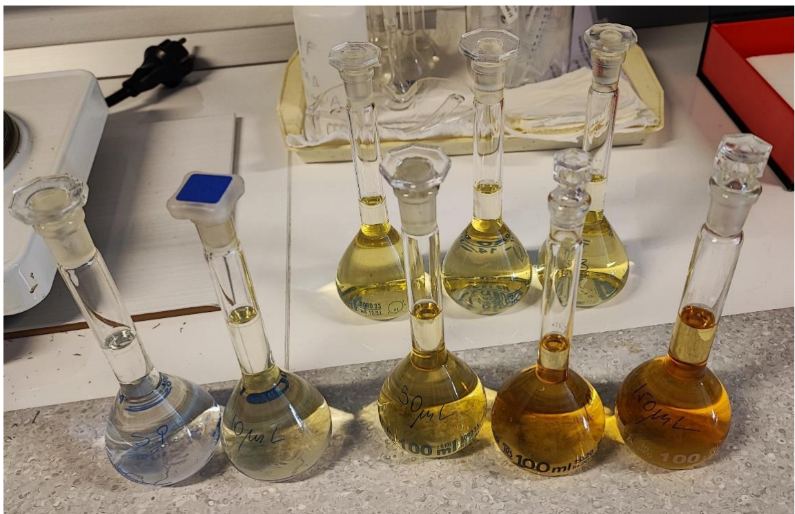
Slika 11. Pripremljeni uzorci standardnih otopina i tala za spektrofotometrijsko određivanje koncentracije amoniyačnog dušika u tlu
