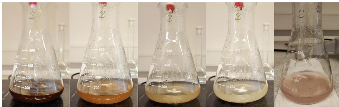
Slika 9. Titracija suviška \text{KMnO}_4 s 0,05 M \text{H}_2\text{C}_2\text{O}_4 do obezbojenja i retitracija suviška \text{H}_2\text{C}_2\text{O}_4 s 0,02 M \text{KMnO}_4 do ružičastog obojenja
