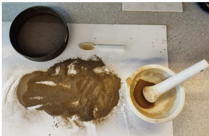
Slika 7. Usitnjavanje i prosijavanje uzoraka tala
