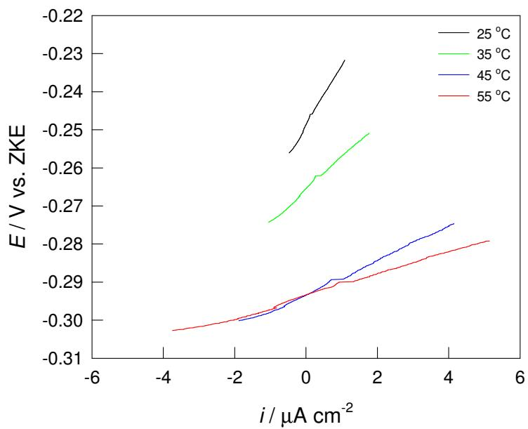
**Slika 12.** Krivulje linearne polarizacije za Cu u  $0,5 \text{ mol dm}^{-3}$   $\text{NaCl}$  otopini uz dodatak 4 ml propolisa pri različitim temperaturama elektrolita
