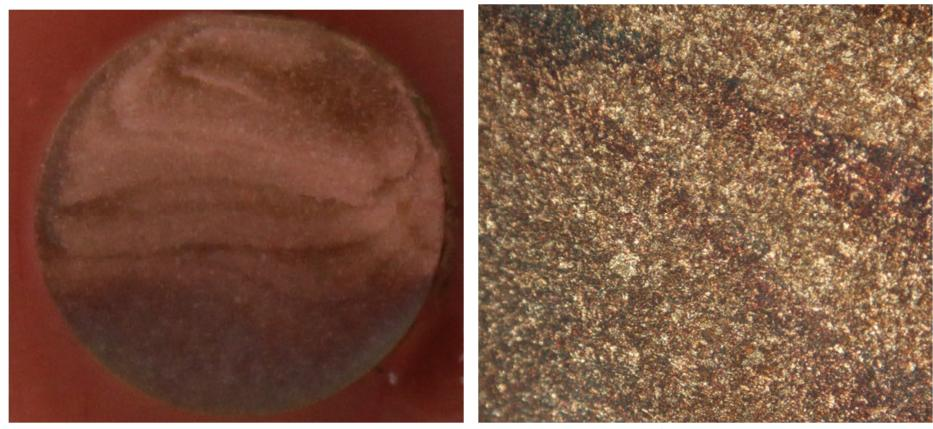
**Slika 19.** Površina Cu elektrode nakon potenciodinamičkog polarizacijskog ispitivanja u mirujućoj NaCl otopini pri  $T = 45^{\circ}\text{C}$ : a) makro snimka površine, b) snimka optičkim mikroskopom uz uvećanje 100 puta
