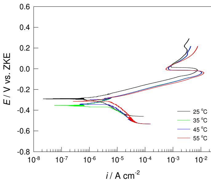
**Slika 15.** Potenciodinamičke polarizacijske krivulje za Cu u  $0,5 \text{ mol dm}^{-3}$  NaCl otopini uz dodatak 4 ml propolisa pri različitim temperaturama elektrolita
