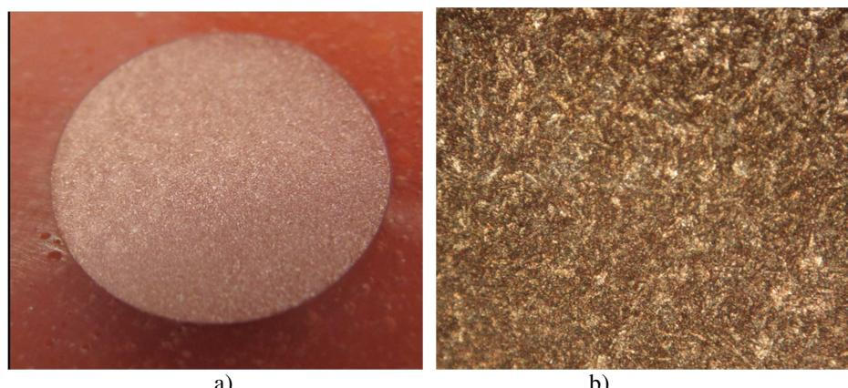
**Slika 17.** Površina Cu elektrode nakon potenciodinamičkog polarizacijskog ispitivanja u mirujućoj NaCl otopini pri  $T = 25\text{ }^{\circ}\text{C}$ : a) makro snimka površine, b) snimka optičkim mikroskopom uz uvećanje 100 puta
