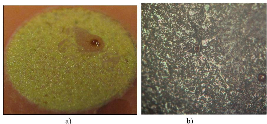
**Slika 22.** Površina Cu elektrode nakon potenciodinamičkog polarizacijskog ispitivanja u mirujućoj NaCl otopini uz dodatak propolisa u otopinu, pri  $T = 35 \text{ }^{\circ}\text{C}$ : a) makro snimka površine, b) snimka optičkim mikroskopom uz uvećanje 100 puta
