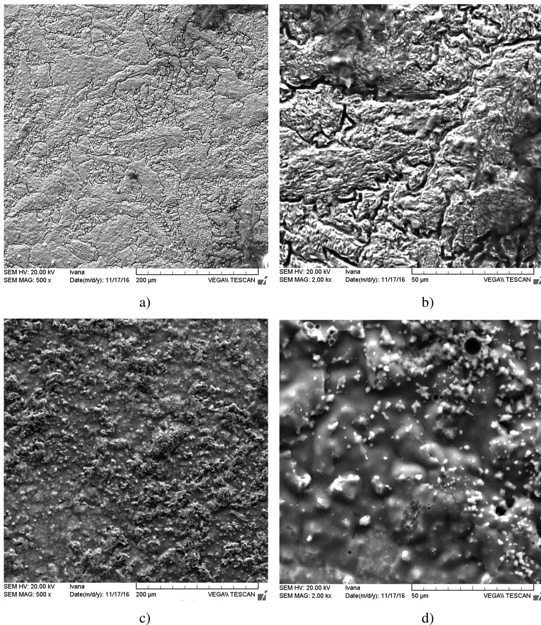
**Slika 29.** SEM snimka površine elektroda nakon polarizacijskih mjerena u  $0,5 \text{ mol dm}^{-3}$   $\text{NaCl}$  otopini pri  $T = 55^\circ\text{C}$  a) uvećanje 500 puta, b) uvećanje 2000 puta, c) u prisustvu 4 ml propolisa, uvećanje 500 puta, c) u prisustvu 4 ml propolisa, uvećanje 2000 puta
