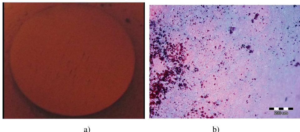
**Slika 25.** Površina Cu elektrode zaštićene propolisom nakon potenciodinamičkog polarizacijskog ispitivanja u mirujućoj NaCl otopini pri  $T = 25^{\circ}\text{C}$ : a) makro snimka površine, b) snimka optičkim mikroskopom uz uvećanje 100 puta
