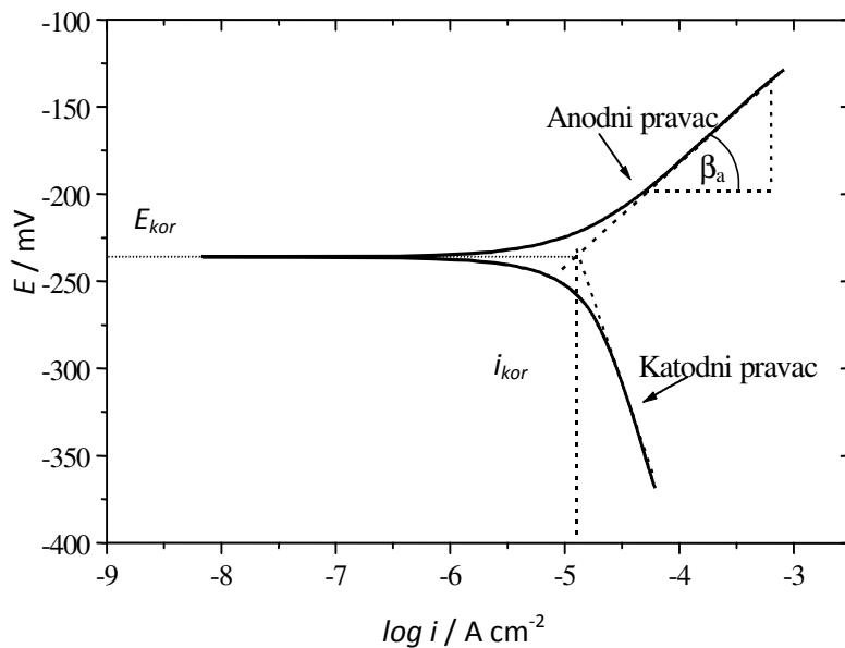
Slika 4. Tafelova metoda određivanja korozijskih parametara iz polarizacijskih mjerena<sup>(33)</sup>
