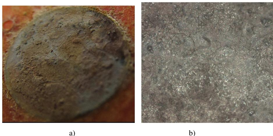
**Slika 26.** Površina Cu elektrode zaštićene propolisom nakon potenciodinamičkog polarizacijskog ispitivanja u mirujućoj NaCl otopini pri  $T = 35^{\circ}\text{C}$ : a) makro snimka površine, b) snimka optičkim mikroskopom uz uvećanje 100 puta
