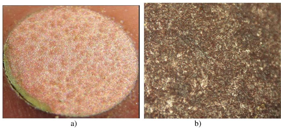
**Slika 20.** Površina Cu elektrode nakon potenciodinamičkog polarizacijskog ispitivanja u mirujućoj NaCl otopini pri  $T = 55^{\circ}\text{C}$ : a) makro snimka površine, b) snimka optičkim mikroskopom uz uvećanje 100 puta
