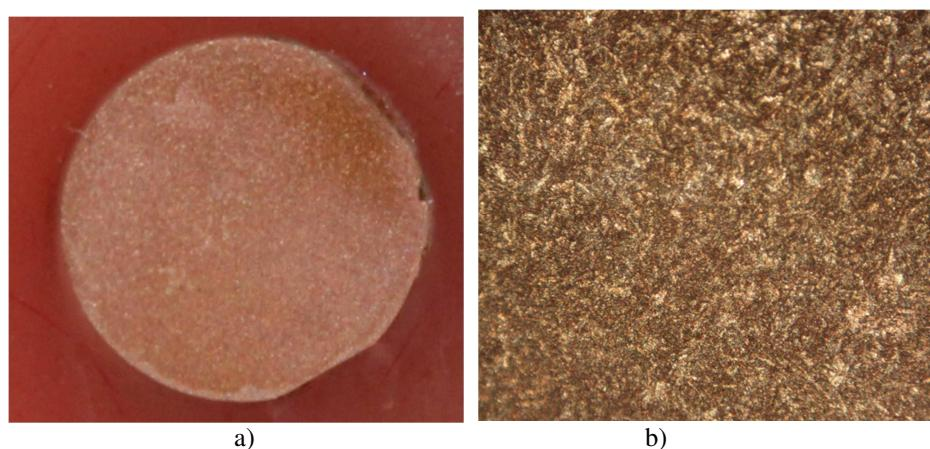
**Slika 18.** Površina Cu elektrode nakon potenciodinamičkog polarizacijskog ispitivanja u mirujućoj NaCl otopini pri  $T = 35\text{ }^{\circ}\text{C}$ : a) makro snimka površine, b) snimka optičkim mikroskopom uz uvećanje 100 puta
