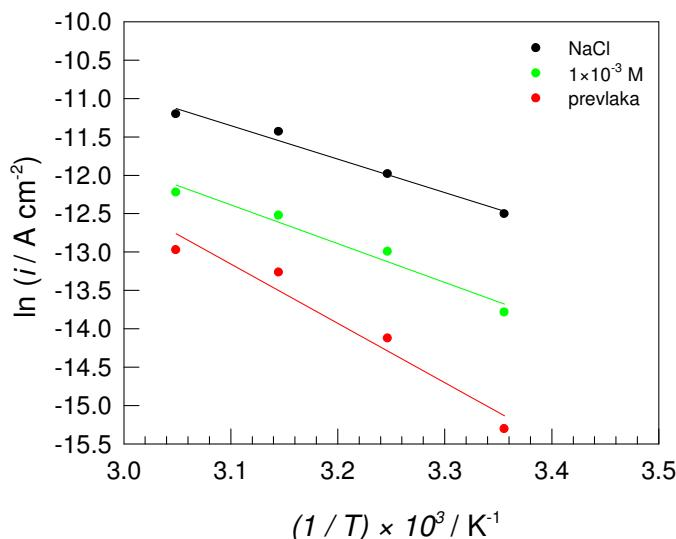
**Slika 30.** Grafička ovisnost logaritma gustoće korozijske struje o recipročnoj vrijednosti temperature elektrolita za Cu u  $0,5 \text{ mol dm}^{-3}$  NaCl otopini bez i u prisustvu propolisa u otopini ili kao prevlaka.
