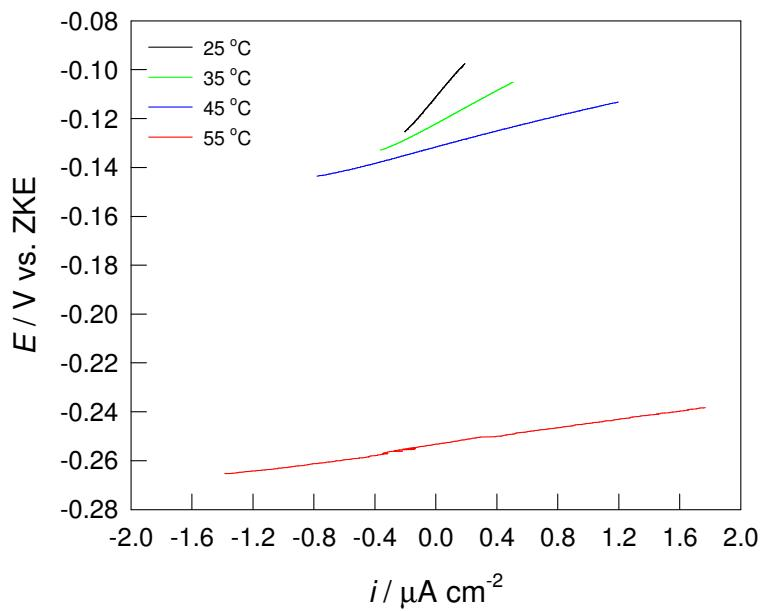
**Slika 13.** Krivulje linearne polarizacije za Cu s prevlakom propolisa u  $0,5 \text{ mol dm}^{-3}$   $\text{NaCl}$  otopini pri različitim temperaturama elektrolita
