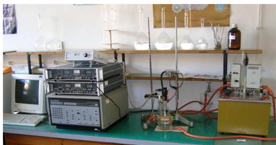
**Slika 6.** Aparatura za provedbu elektrokemijskih mjerena
