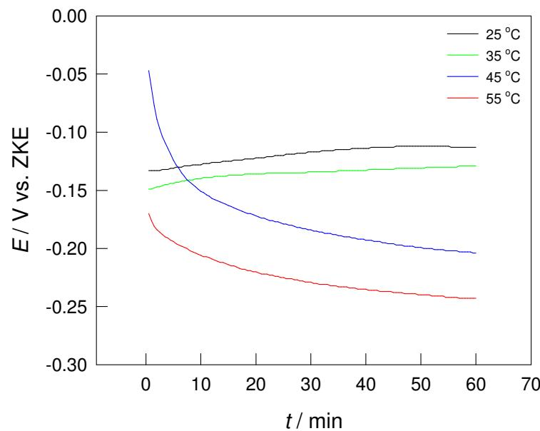
Slika 10. Potencijal otvorenog strujnog kruga za Cu s prevlakom propolisa u  $0,5 \text{ mol dm}^{-3}$   $\text{NaCl}$  otopini pri različitim temperaturama elektrolita
