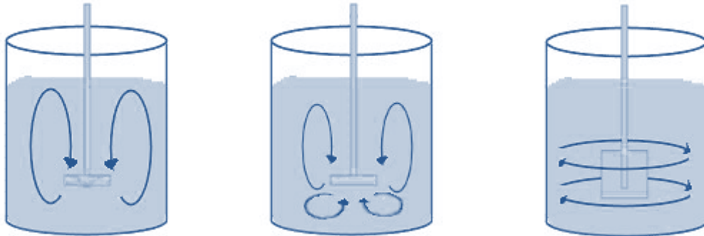
a) aksijalni tok fluida b) radijalni tok fluida c) tangencijalni tok fluida
