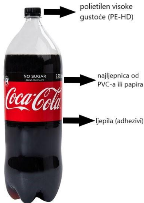
Slika 7. Dijelovi PET boce 24 koji se uklanjaju prije recikliranja
