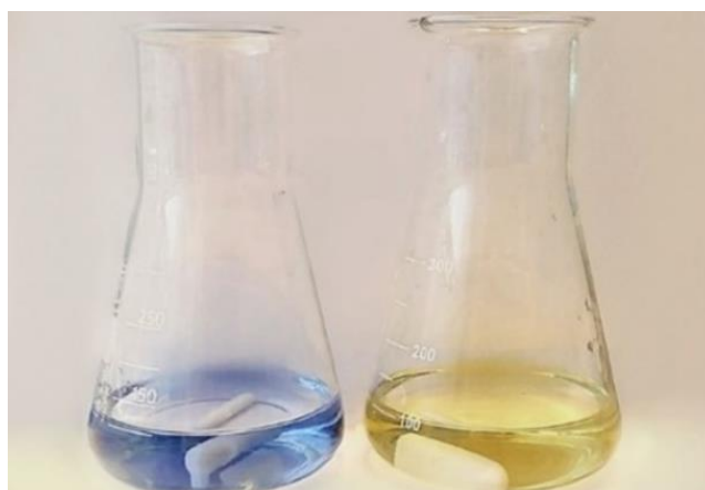
Slika 2.2. Prikaz prijelaza boje pri kompleksometrijskoj titraciji u točki ekvivalencije.
