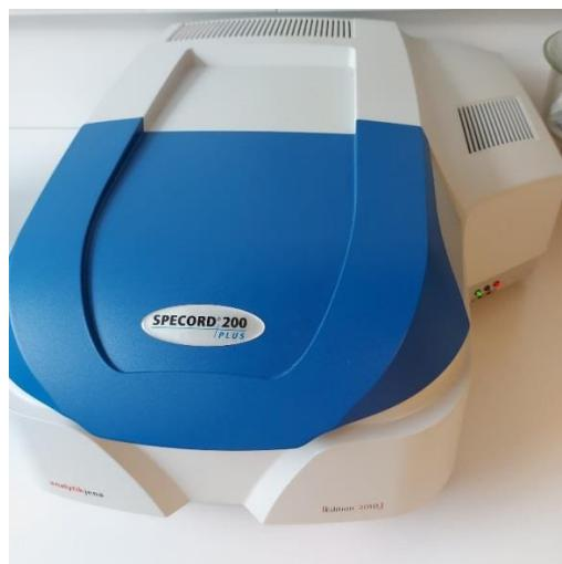
Slika 6. Spektrofotometar SPECORD 200 Plus
