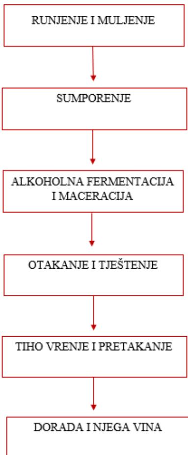
Slika 2. Shematski prikaz tehnološkog procesa proizvodnje crnih vina
