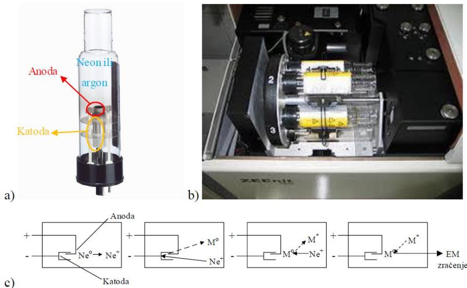
**Slika 6.** a) Žarulja sa šupljom katodom ; b) Sustav sa više žarulja u jednom uređaju ; c) Princip rada i emitiranja žarulje sa šupljom katodom<sup>14</sup>
