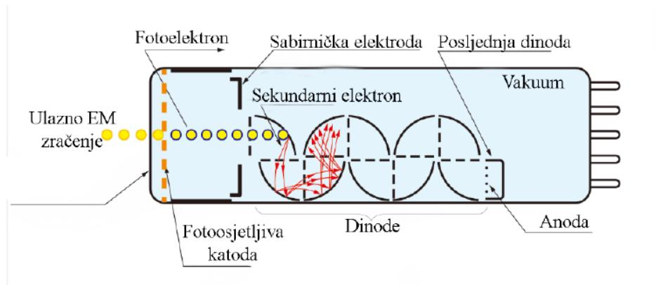
**Slika 9.** Shematski prikaz fotomultiplikatora<sup>14</sup>
