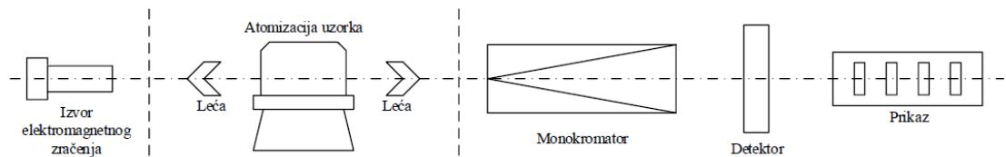
**Slika 5.** Shema atomskog apsorpcijiskog spektrometra<sup>14</sup>
