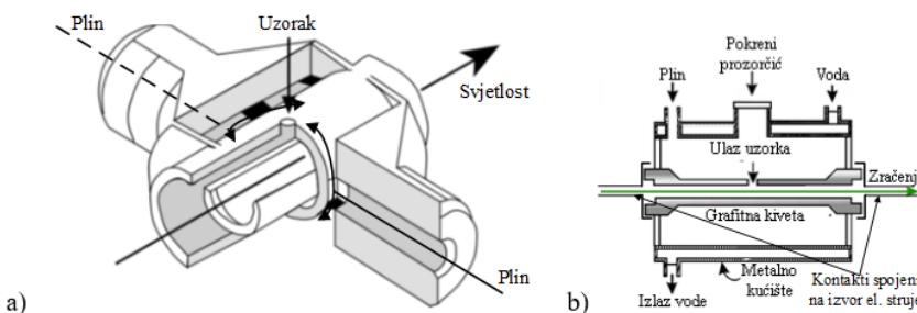
Slika 11. a) Grafitna kiveta ; b) Prikaz grafitne kivete u peći<sup>14</sup>
