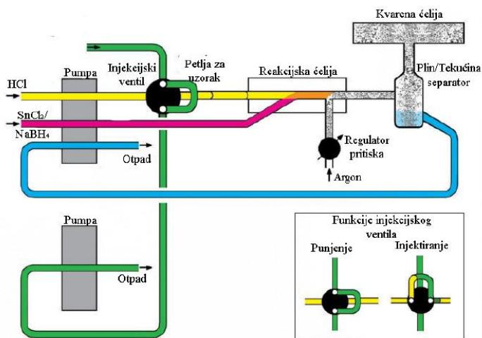
Slika 12. Princip rada hidridne tehnike<sup>14</sup>
