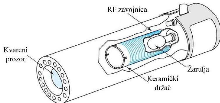
**Slika 7.** Bezelektrodna žarulja<sup>14</sup>
