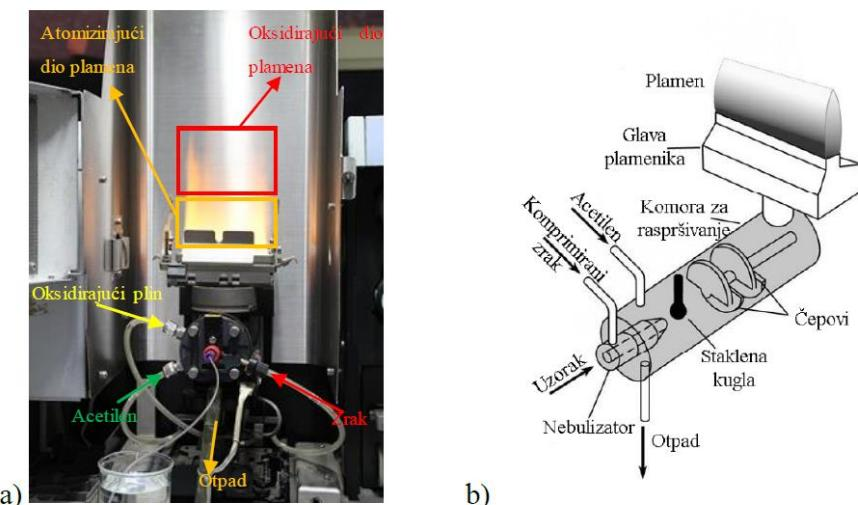
Slika 10. a) Atomizacija plamenom ; b) Shematski prikaz atomizacije plamenom<sup>14</sup>
