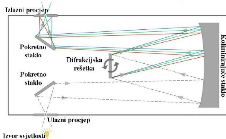
**Slika 8.** Shematski prikaz monokromatora<sup>14</sup>
