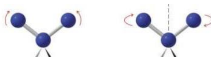
Slika 16. Simetrično i asimetrično rastezanje
