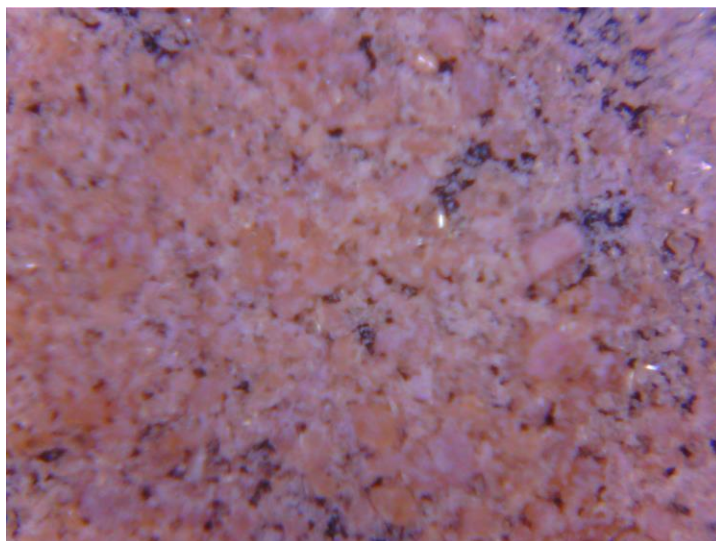
Slika 30. Površina modificirane radne elektrode - 2 sloja Co-BPY/6-Onic snimljena svjetlosnim mikroskopom.
