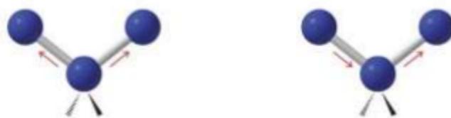
Slika 16. Simetrično i asimetrično rastezanje
