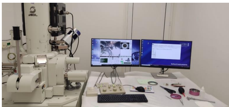
Slika 25. SEM/EDS JEOL JSM - 7610F Plus.
