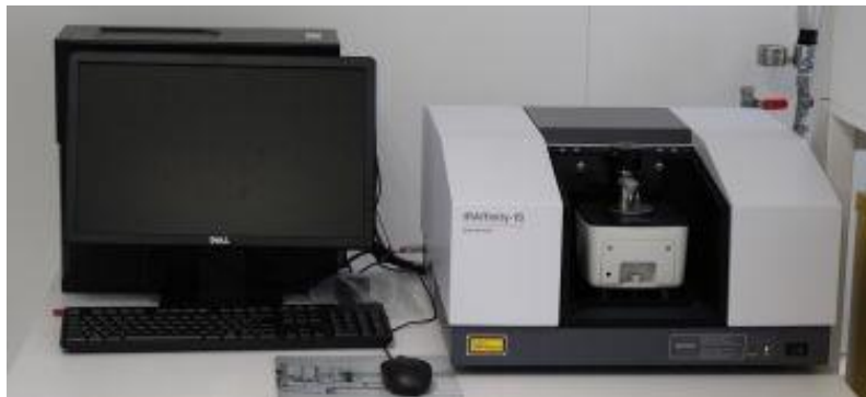
Slika 26. Preša za pravljenje pastila i uređaj za FTIR analizu.
