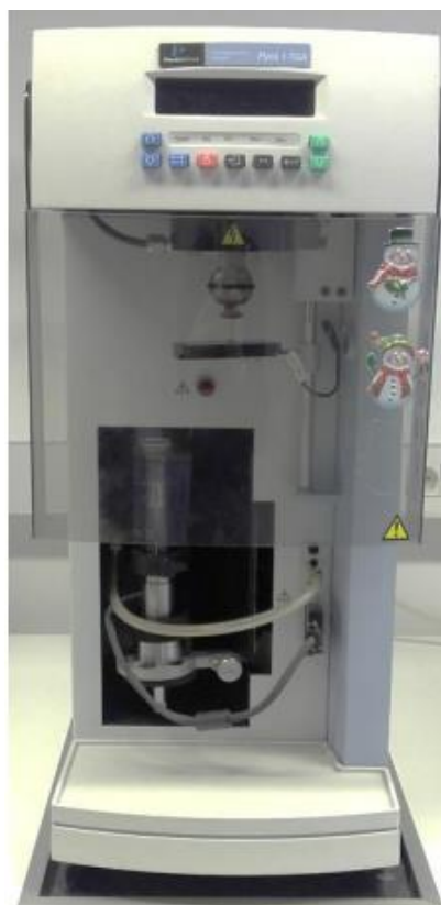
Slika 16. Aparatura za termogravimetrijsku analizu, Pyris 1 TGA (Perkin-Elmer)
