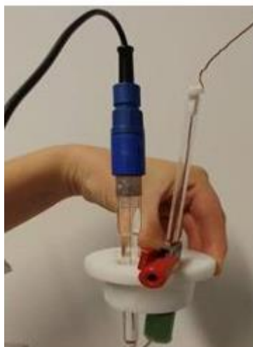
Slika 2.3.3.2. Referentna elektroda (lijevo) i protuelektroda (desno)
