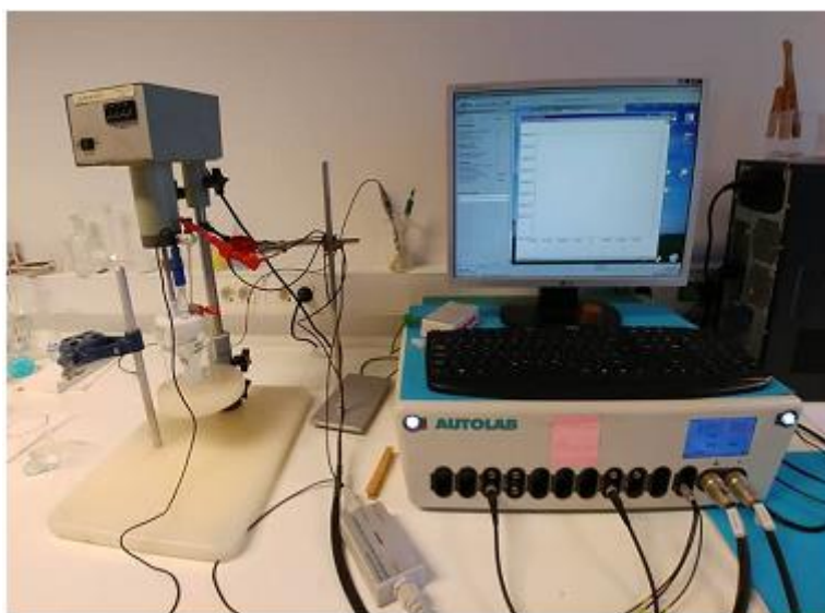
Slika 2.3.1. Uređaj za elektrokemijska mjerenja
