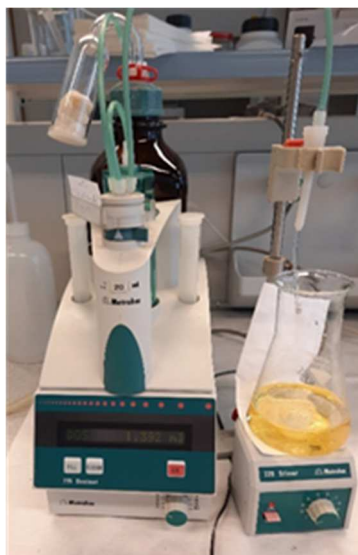
Slika 2.2. Prijelaz boje pri kompleksometrijskom određivanju olova na automatskom titratoru „Metrohm 775 Dosimat“
