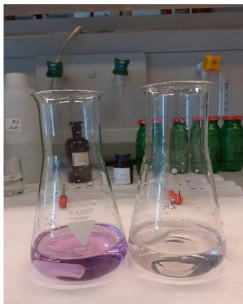
Slika 2.4. Promjena boje pri kompleksometrijskom određivanju cinka uz indikator 3,3 dimetilnaftidin
