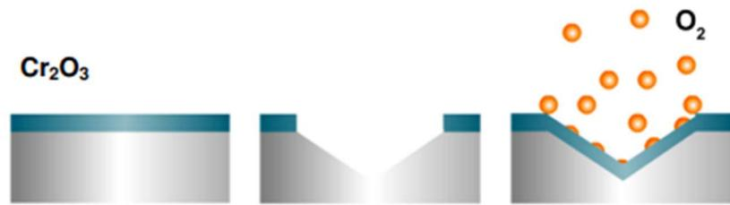
**Slika 1.13.** Prikaz mehanizma repasivacije (samoobnavljanja) pasivnog filma kromovog oksida na površini materijala.<sup>25</sup>
