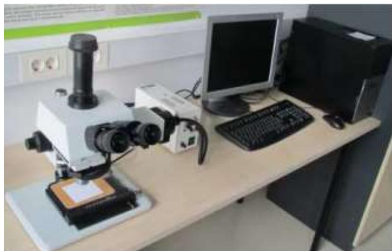
Slika 2.4. Optički mikroskop MXFMS-BD, Ningbo Sunny Instruments co.
