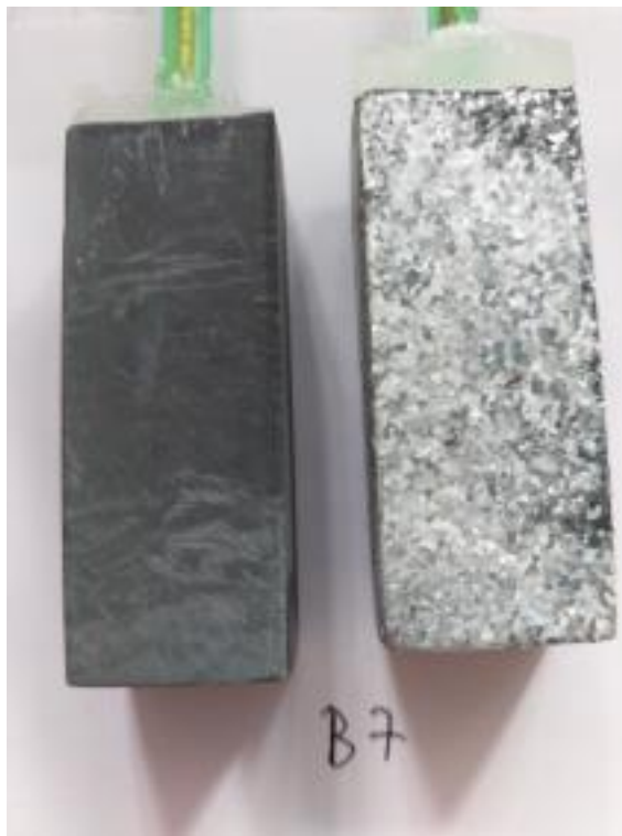
Slika 20. Zn anoda (lijevo) i katoda (desno) nakon procesa elektrokoagulacije
