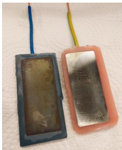
Slika 14. Fe anoda (lijevo) i katoda (desno) nakon procesa elektrokoagulacije
