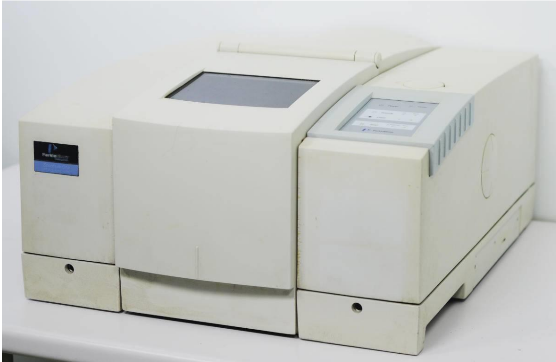
Slika 17. FT-IR spektrometar Spectrum One (Perkin Elmer) 27
