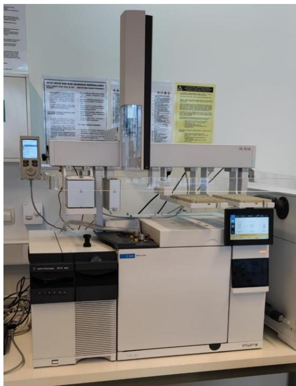
**Slika 13.** Vezani sustav plinska kromatografija sa spektrometrijom masa (GC-MS)
