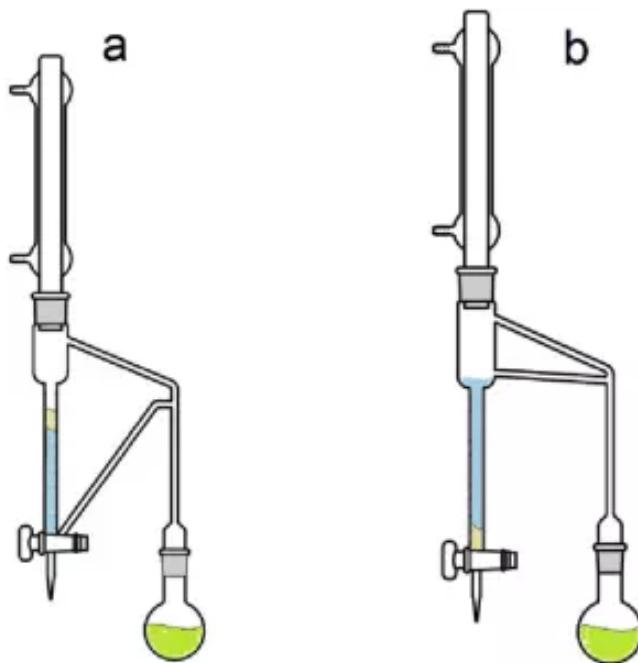
**Slika 9.** Aparatura po Clevengeru; a) za eterična ulja manje gustoće od vode;
