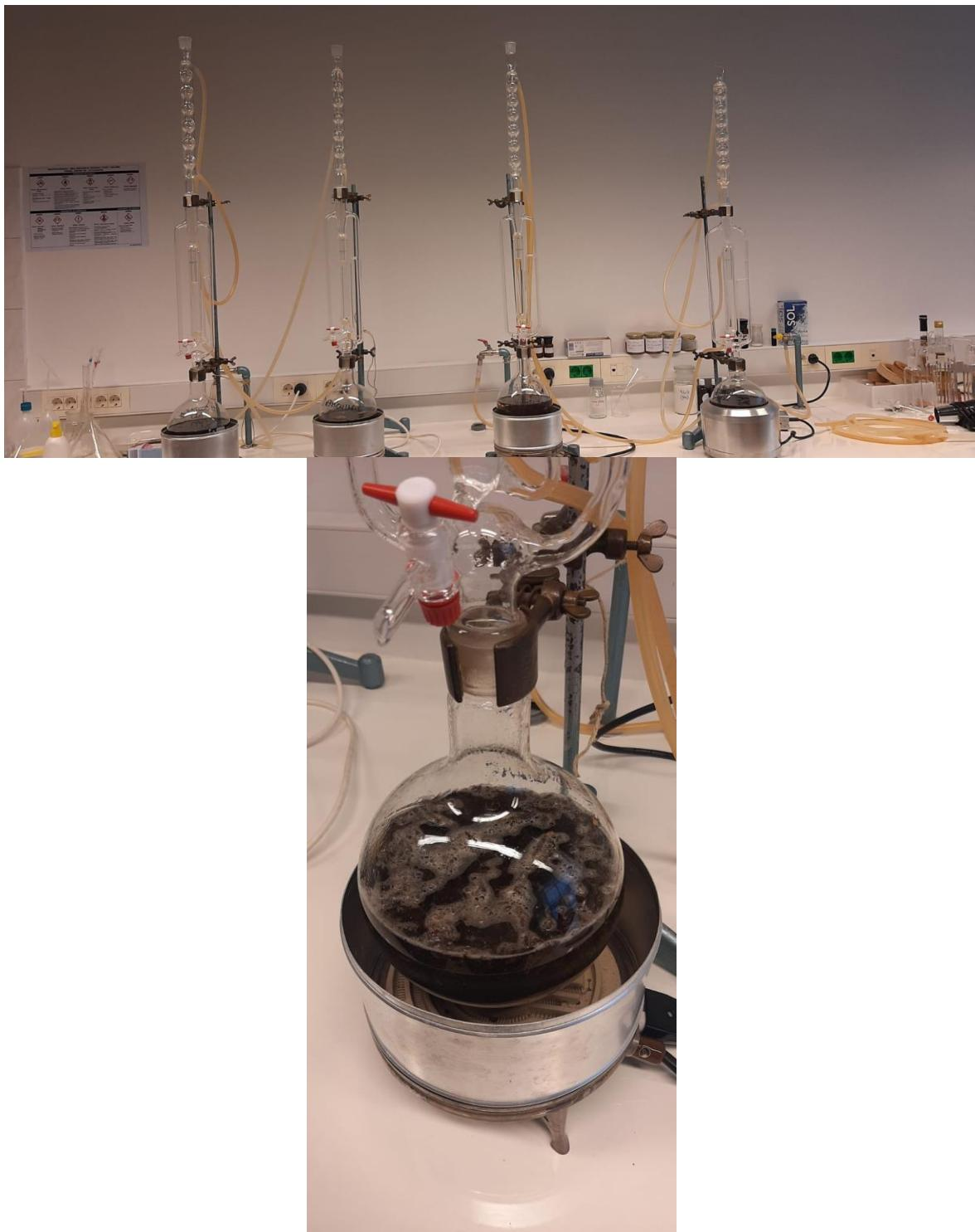
**Slika 12.** Modificirana aparatura po Clevengeru
