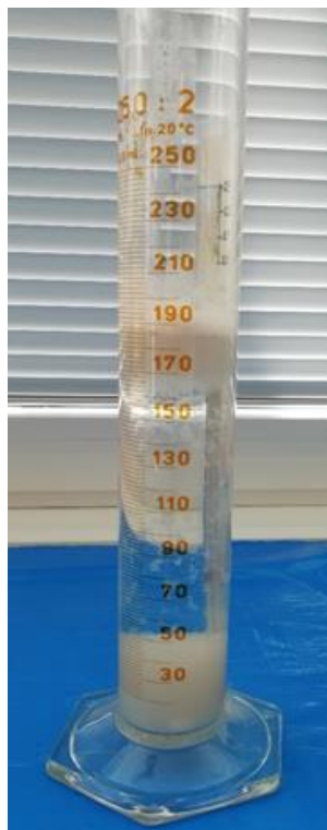
Slika 2.6. Menzura sa uzorkom tijekom testa taloženja.
