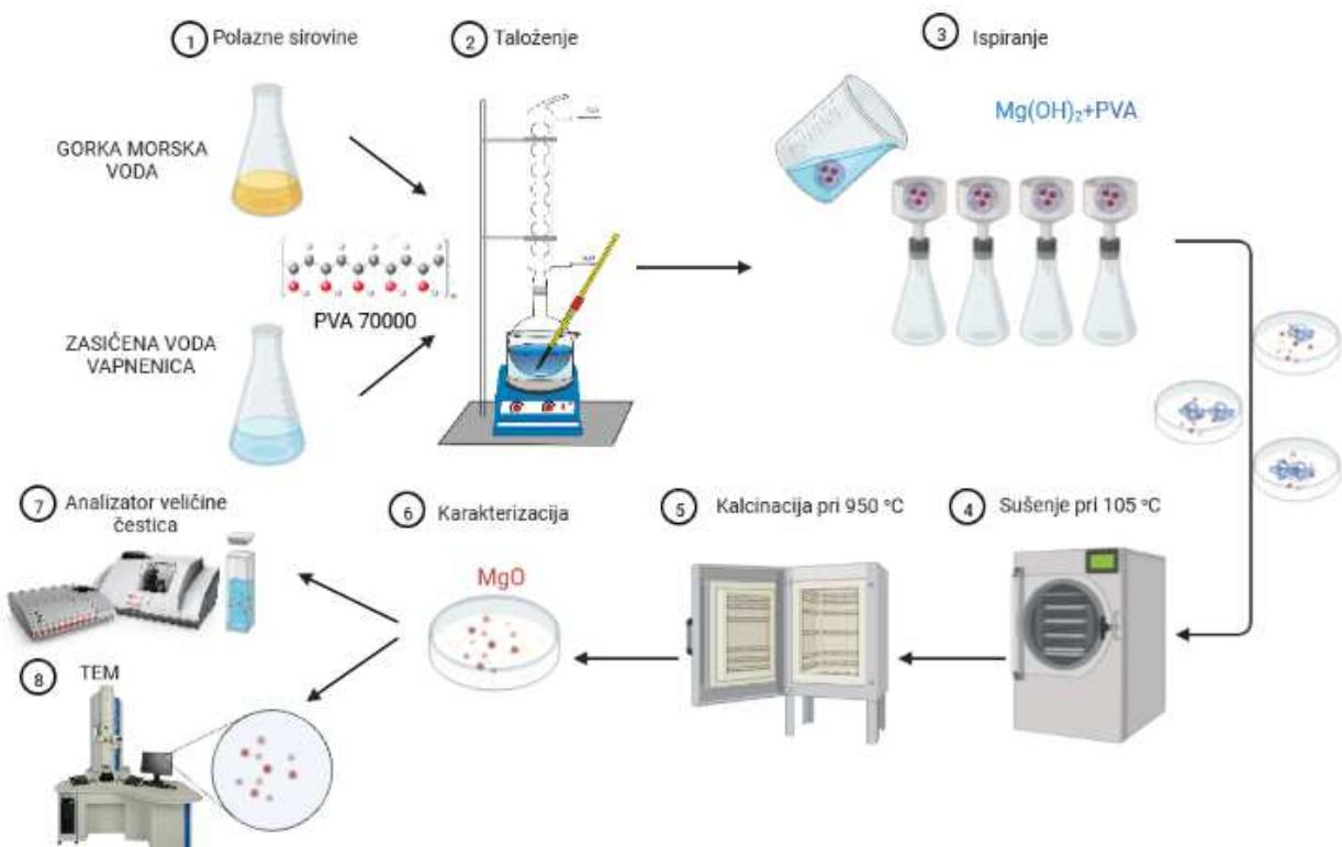
Slika 20. Shema procesa precipitacije magnezijeva oksida.
