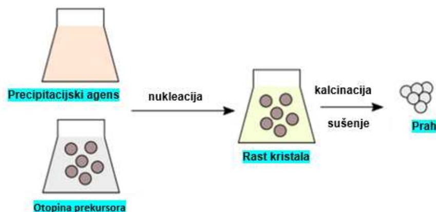
Slika 7. Shematski prikaz procesa koprecipitacije.<sup>24</sup>
