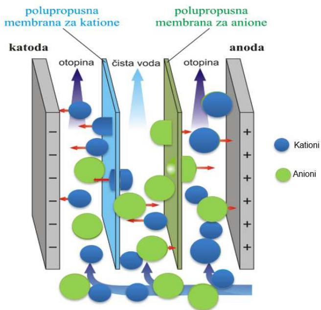
Slika 4. Shematski prikaz rada elektrodijalize.<sup>7</sup>
