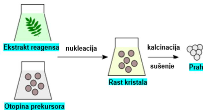
Slika 18. Shematski prikaz procesa zelene sinteze.<sup>24</sup>
