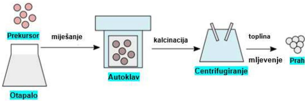
Slika 5. Shematski prikaz solvo/hidrotermalne sinteze.<sup>24</sup>
