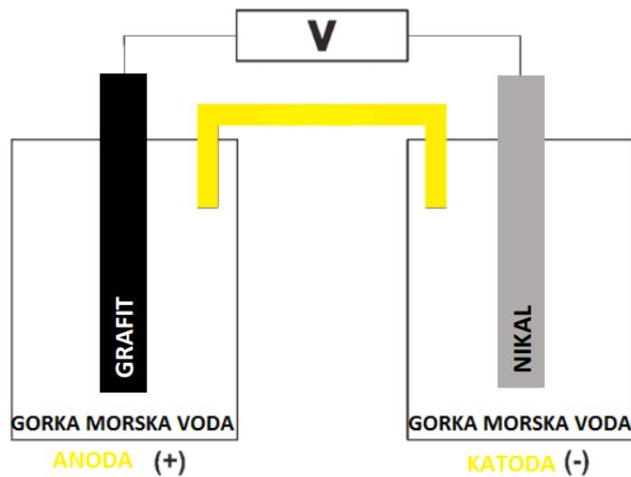
Slika 3. Shematski prikaz rada elektrolize za dobivanje  $Mg(OH)_2$ .<sup>5</sup>
