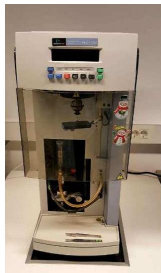
Slika 22. Termogravimetar Pyris TGA.
