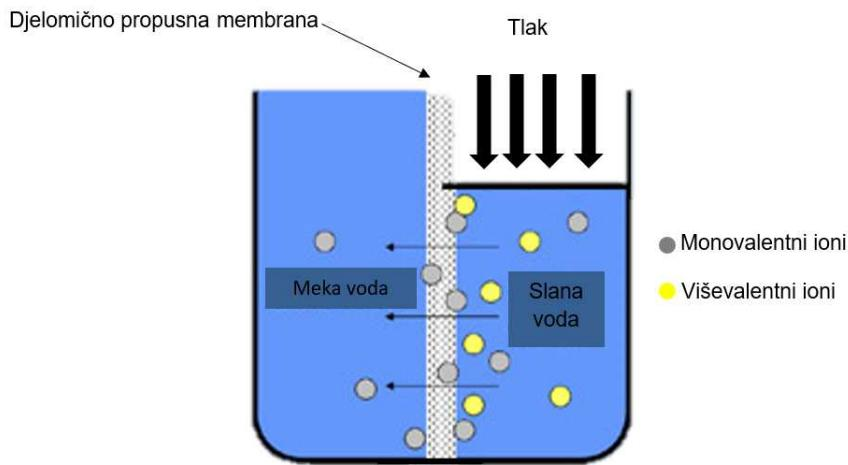
Slika 2. Shematski prikaz nanofiltracije.<sup>3</sup>
