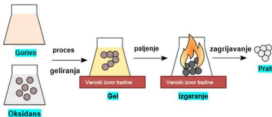
Slika 6. Shematski prikaz metode izgaranja.<sup>24</sup>
