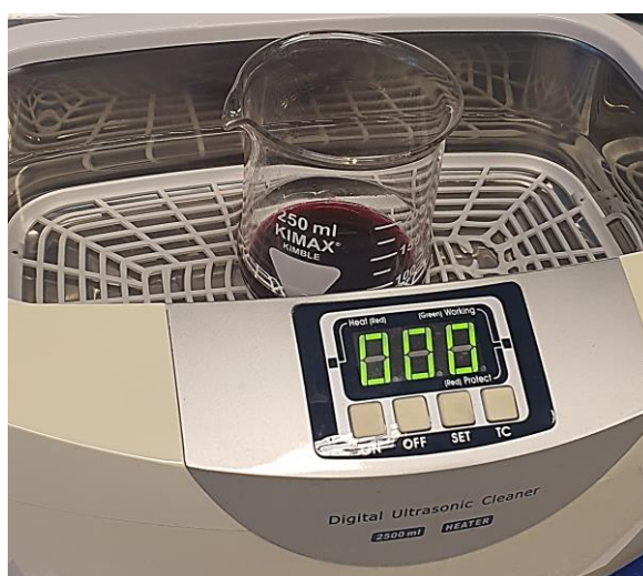
Slika 30. Potpomognuta ekstrakcija antocijanina u ultrazvučnoj kupelji
