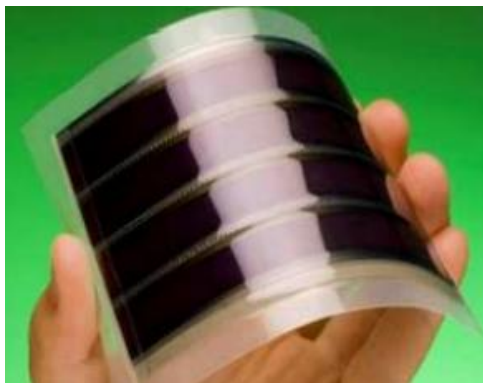
Slika 19. Tankoslojna ćelija na osnovi nanokristaličnog \text{TiO}_2 28
