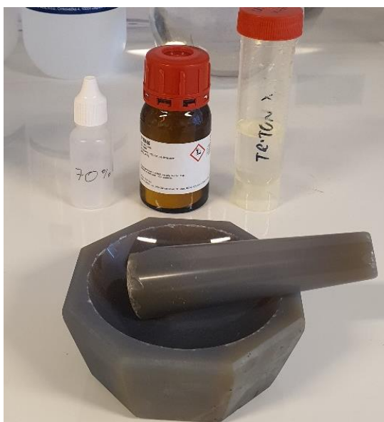
Slika 34. Korišteni pribor i kemikalije pri izradi ZnO paste
