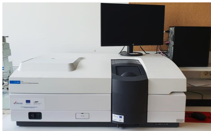
Slika 52. UV – Vis – NIR spektrofotometar korišten za određivanje valnog područja antocijanina
