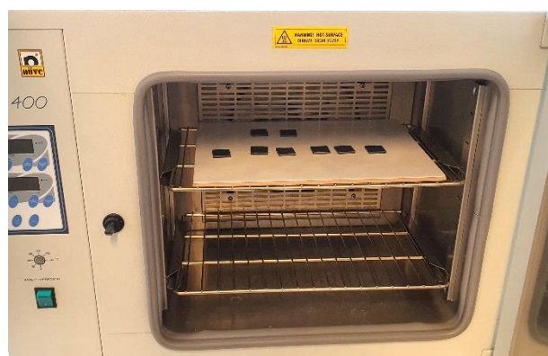
Slika 46. Sušenje sloja grafita u sušioniku pri temperaturi 60 °C
