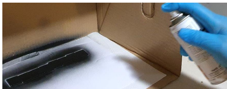
Slika 45. Nanošenje sloja grafita tehnikom naprsakavanja
