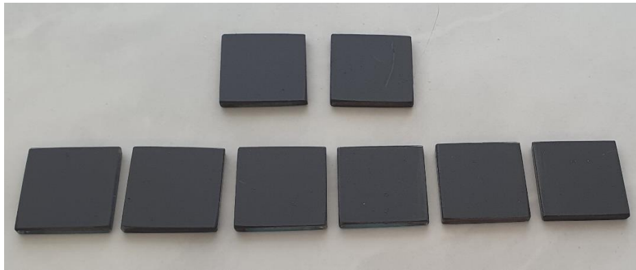
Slika 47. Ćelije s osušenim slojem grafita
