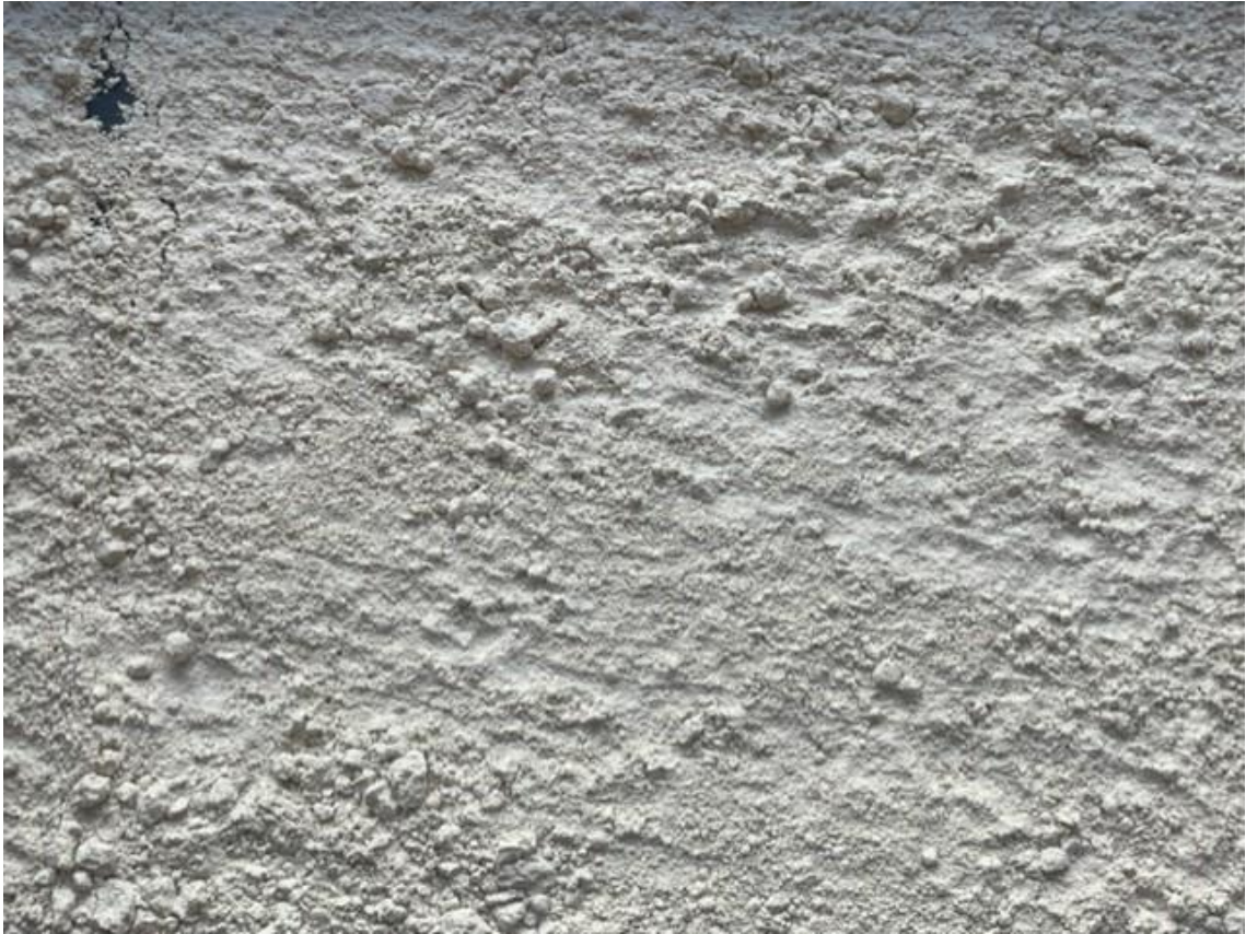
Slika 2.1. Usitnjene čestice zeolita NaX
