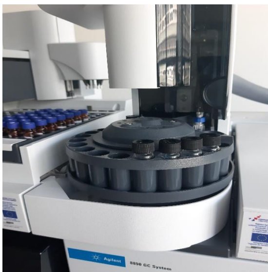
Slika 28. Uzorci postavljeni u GC-MS uređaj
