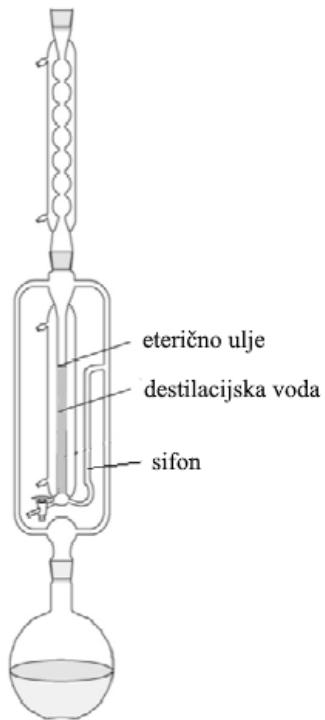
**Slika 12.** Modificirana aparatura prema Clevengeru<sup>7</sup>
