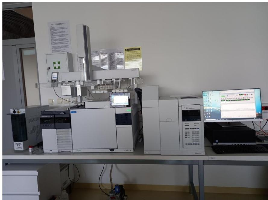
**Slika 21.** Vezani sustav plinska kromatografija-spektrometrija masa (GC-MS)
