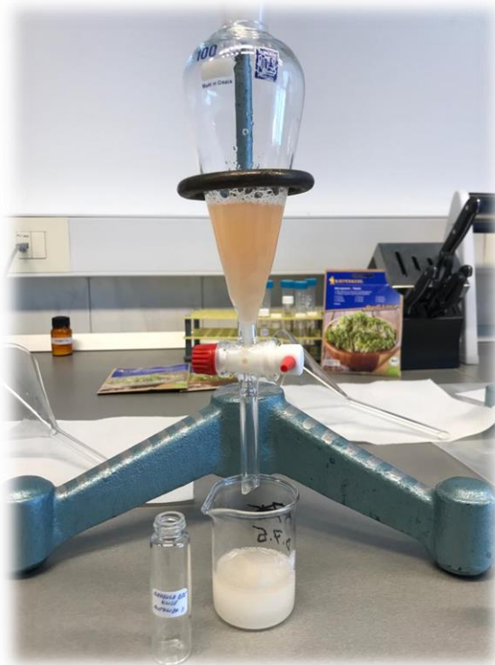
Slika 2.11. Ekstrakcija hlapljivih razgradnih produkata glukozinolata diklormetanom.
