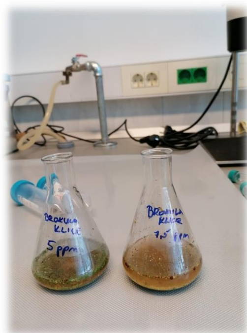
Slika 2.10. Uzorci klica brokule stavljeni na autolizu uz dodatak enzima mirozinaze.
