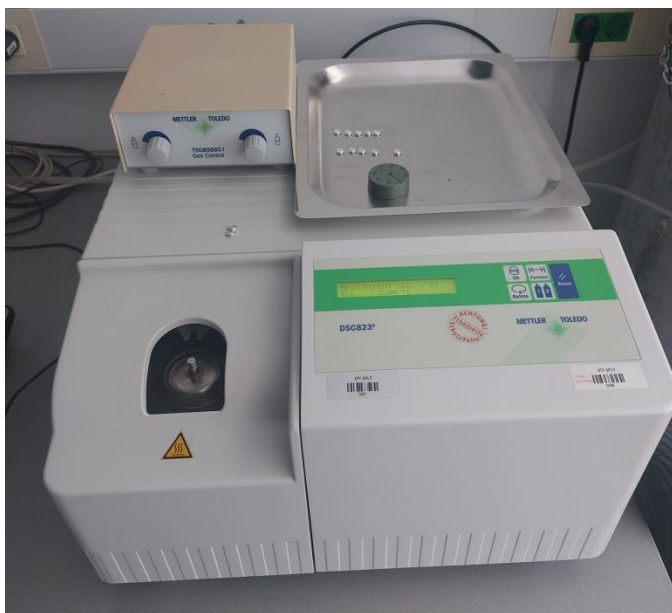
Slika 13. Diferencijalni pretražni kalorimetar, model DSC 823 e
