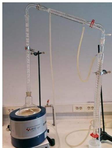
Slika 17. Destilacija uzorka komovice
