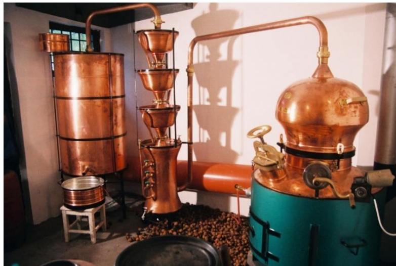
Slika 4. Uređaj za destilaciju s deflagmatorom [19]
