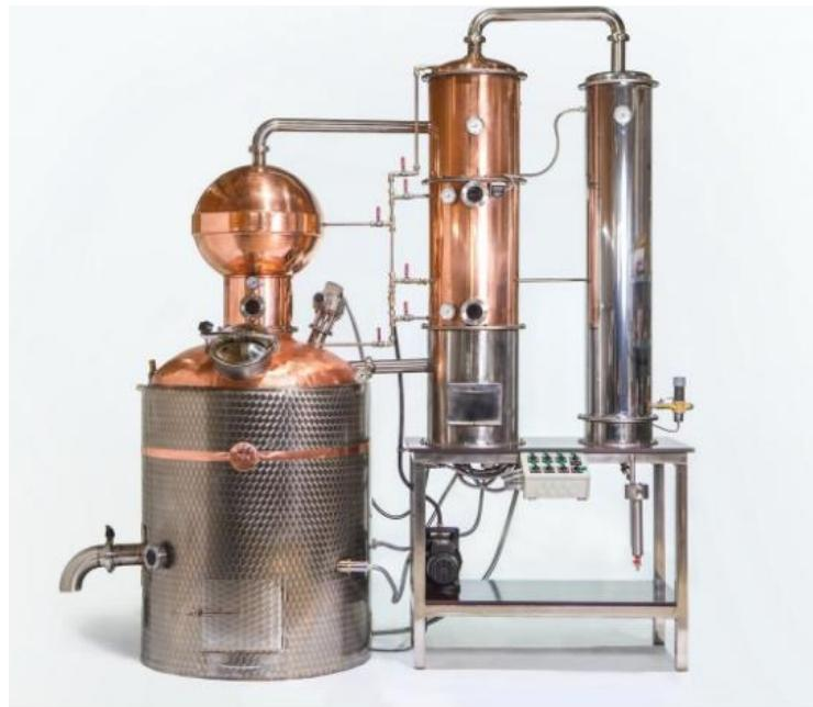
Slika 5. Uređaj za destilaciju s rektifikacijskom kolonom [20]
