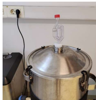
Slika 9. Vrenjača postavljena na poklopac fermentora
