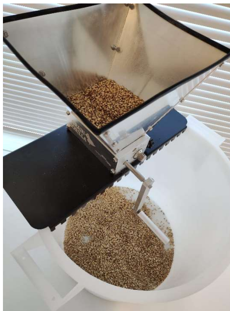
Slika 15. Postupak mljevenja slada pomoću ručnog mlina
