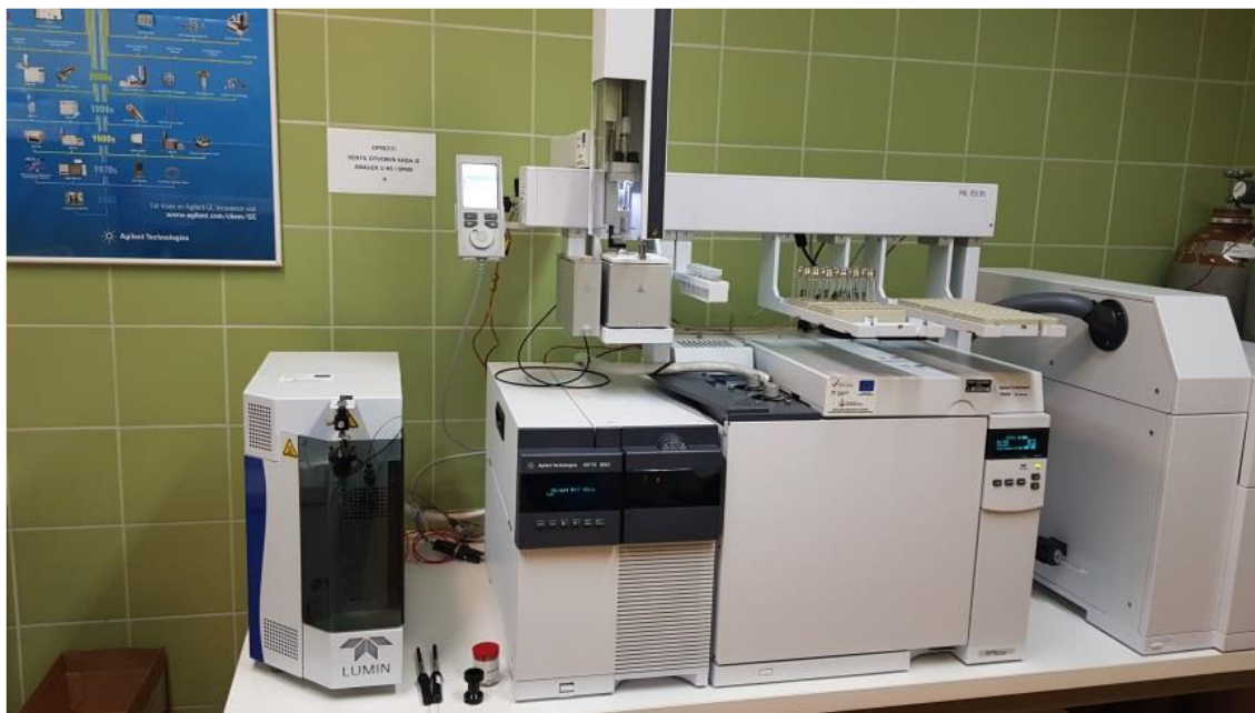
Slika 16. Vezani sustav plinska kromatografija-spektrometrija masa (GC-MS)
