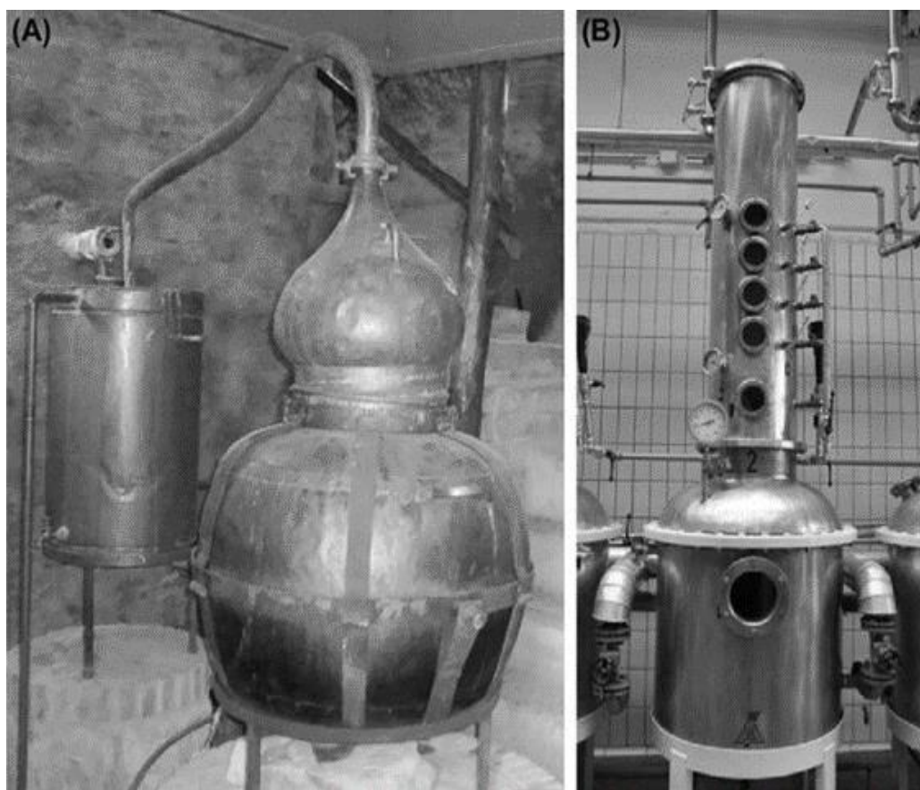
Slika 5. Uređaji za destilaciju: (A) Charentais alembic (francuski stil) i (B) uređaj s kolonama (njemački stil) (26)
