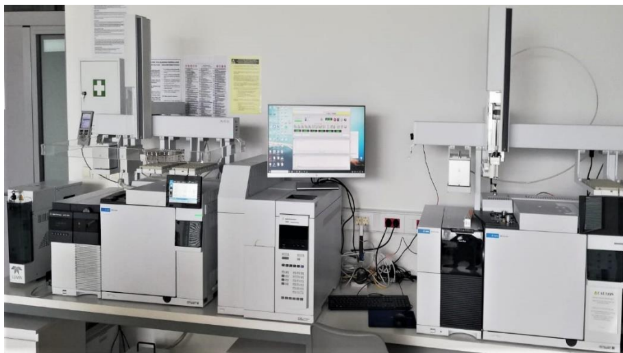
Slika 12. Vezani sustav plinska kromatografija – spektrometrija masa (GC-MS)
