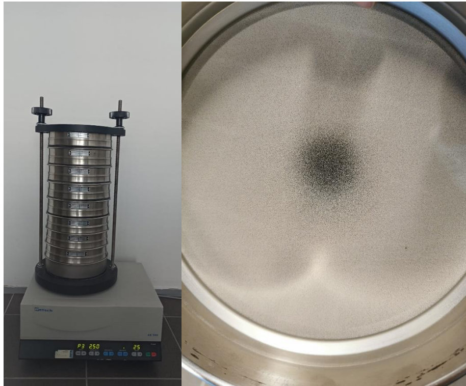
Slika 2.13. Granulometrijska analiza pripremljenih uzoraka biougljena
