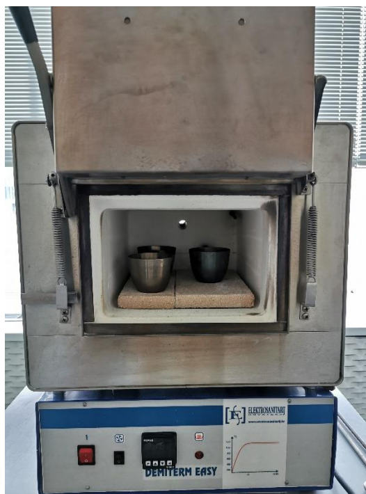
Slika 2.12. Određivanje udjela pepela u pripremljenim uzorcima biougljena
