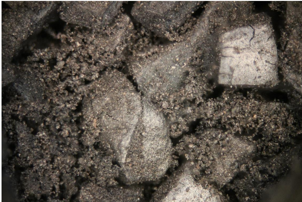
Slika 3.4. Čestice biougljena pripremljenog pri 350°C
