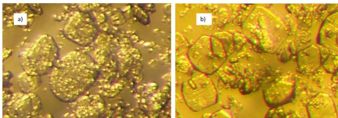
*Slika 23.* Fotografije kristala boraksa u matičnoj otopini analiziranih optičkom lupom uz uvećanje 100 puta u sustavu: a) s djelovanjem ultrazvuka ( $A = 20 \%$ ,  $b = 6 \text{ }^{\circ}\text{C} \text{ h}^{-1}$ ); b) bez djelovanja ultrazvuka ( $A = 20 \%$ ,  $b = 6 \text{ }^{\circ}\text{C} \text{ h}^{-1}$ ).
