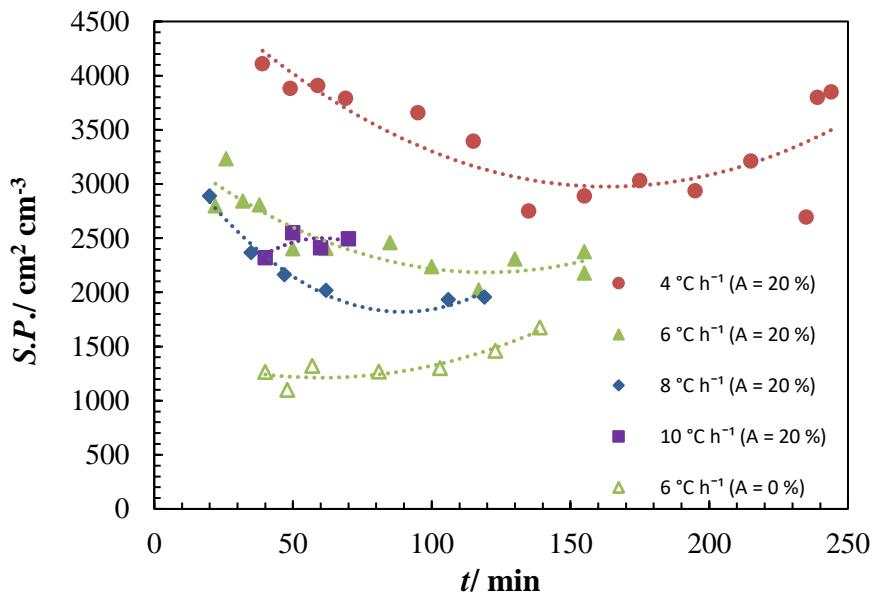
Slika 29. Promjena specifične površine kristala u sustavu s i bez ultrazvuka pri različitim brzinama hlađenja ( $N_{JS} = 324 \text{ o min}^{-1}$ ,  $T_z = 30\text{ }^{\circ}\text{C}$ ).
