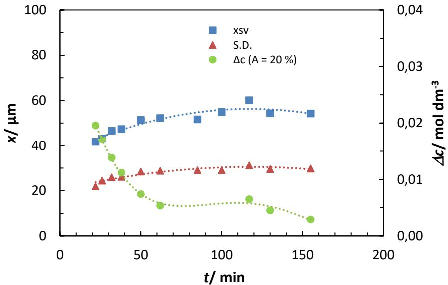
Slika 25. Promjena srednjeg volumnog promjera, standardne devijacije te prezasićenosti matične otopine tijekom procesa sonokristalizacije pri brzini hlađenja od  $6 \text{ }^{\circ}\text{C h}^{-1}$  ( $N_{JS} = 324 \text{ o min}^{-1}$ ,  $A = 20 \%$ ,  $T_z = 30 \text{ }^{\circ}\text{C}$ ).
