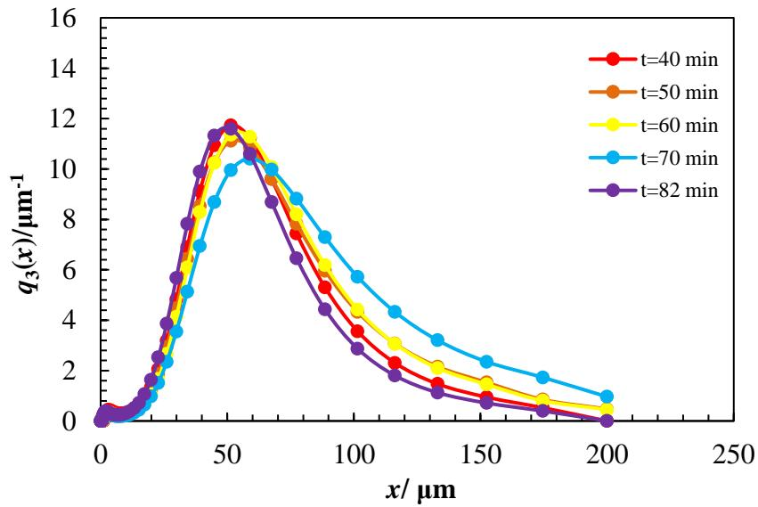
Slika 20. Funkcije gustoće raspodjele kristala tijekom sonokristalizacije pri brzini hlađenja matične otopine od  $10 \text{ } ^\circ\text{C h}^{-1}$  ( $N_{JS} = 324 \text{ o min}^{-1}$ ,  $A = 20 \%$ ,  $T_z = 30 \text{ } ^\circ\text{C}$ ).
