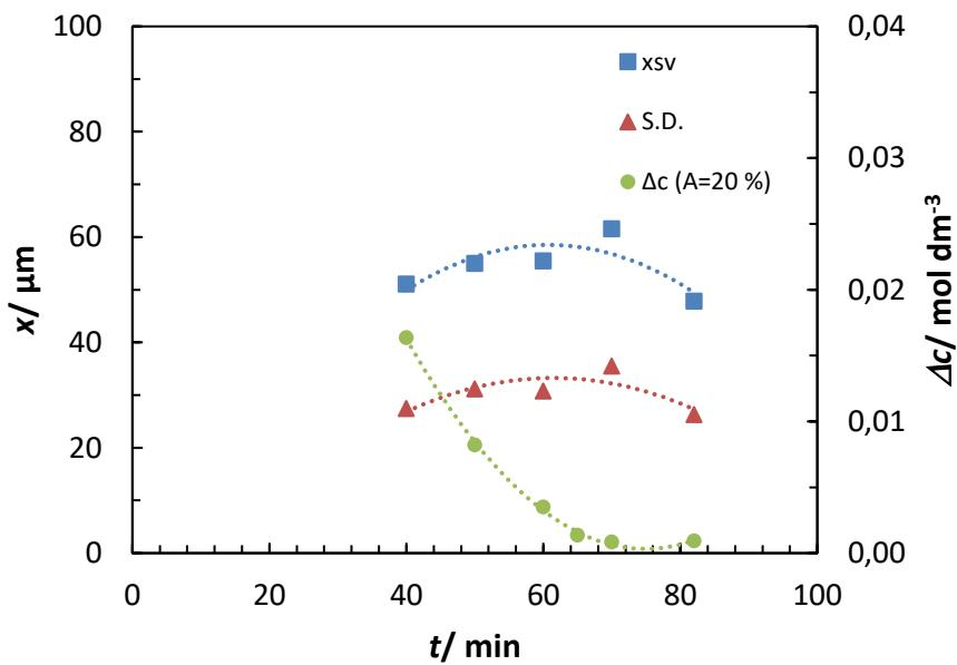
Slika 27. Promjena srednjeg columnog promjera, standardne devijacije te prezasićenosti matične otopine tijekom procesa sonokristalizacije pri brzini hlađenja od  $10\text{ }^{\circ}\text{C h}^{-1}$  ( $N_{JS} = 324 \text{ o min}^{-1}$ ,  $A = 20\%$ ,  $T_z = 30\text{ }^{\circ}\text{C}$ ).
