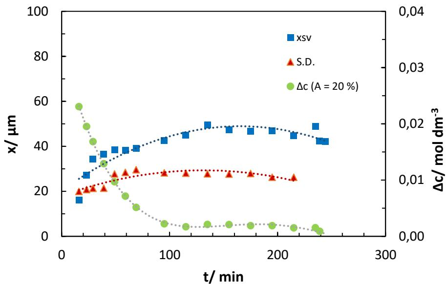
Slika 24. Promjena srednjeg volumnog promjera, standardne devijacije te prezasićenosti matične otopine tijekom procesa sonokristalizacije pri brzini hlađenja od  $4 \text{ }^{\circ}\text{C h}^{-1}$  ( $N_{JS} = 324 \text{ o min}^{-1}$ ,  $A = 20 \%$ ,  $T_z = 30 \text{ }^{\circ}\text{C}$ ).
