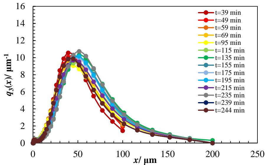
Slika 17. Funkcije gustoće raspodjele kristala tijekom sonokristalizacije pri brzini hlađenja matične otopine od  $4 \text{ } ^\circ\text{C h}^{-1}$  ( $N_{JS} = 324 \text{ o min}^{-1}$ ,  $A = 20 \%$ ,  $T_z = 30 \text{ } ^\circ\text{C}$ ).
