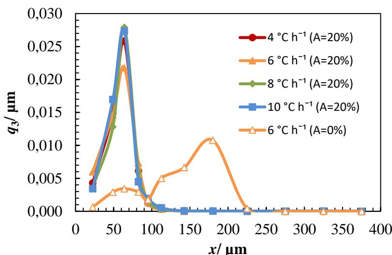
Slika 31. Funkcija gustoće raspodjele kristala finalnog produkta u sustavu s i bez ultrazvuka pri različitim brzinama hlađenja ( $N_{JS} = 324 \text{ } \text{o min}^{-1}$ ,  $T_z = 30 \text{ } ^\circ\text{C}$ ).
