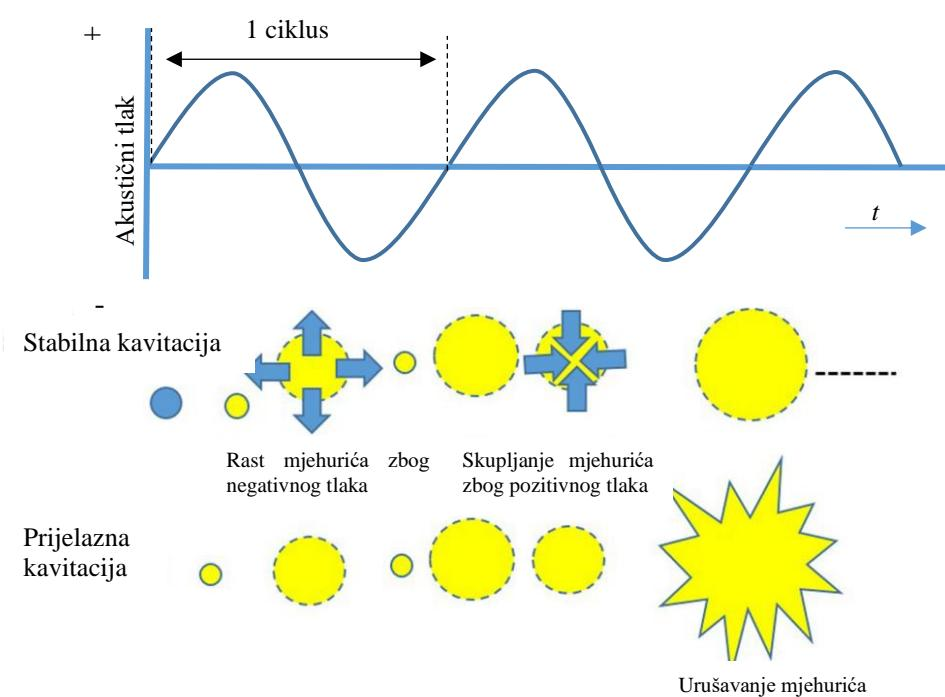
*Slika 7. Ilustracija mehanizma kavitacije [19].*
