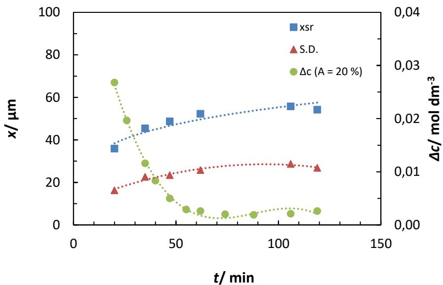
Slika 26. Promjena srednjeg columnog promjera, standardne devijacije te prezasićenosti matične otopine tijekom procesa sonokristalizacije pri brzini hlađenja od  $8\text{ }^{\circ}\text{C h}^{-1}$  ( $N_{JS} = 324 \text{ o min}^{-1}$ ,  $A = 20\%$ ,  $T_z = 30\text{ }^{\circ}\text{C}$ ).
