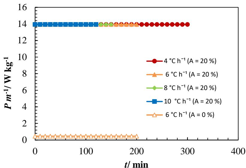
Slika 30. Snaga privedena sustavu tijekom miješanja i ultrazvučnog djelovanja pri ispitivanim brzinama hlađenja u sustavu s i bez ultrazvuka ( $N_{JS} = 324 \text{ o min}^{-1}$ ,  $T_z = 30 \text{ }^{\circ}\text{C h}^{-1}$ ).
