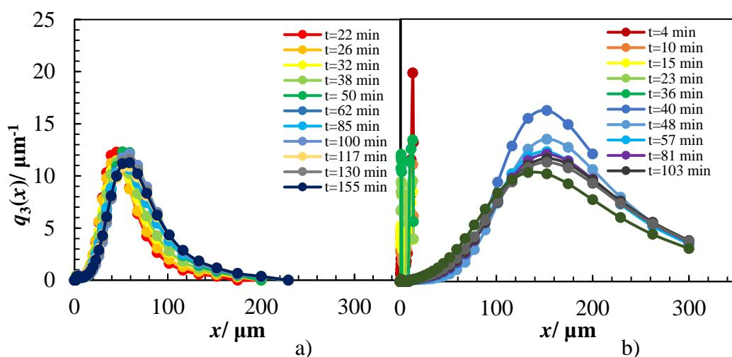
*Slika 22.* Funkcije gustoće raspodjele kristala pri brzini hlađenja matične otopine od  $6 \text{ } ^\circ\text{C h}^{-1}$  u sustavu: a) s ultrazvučnim djelovanjem b) bez ultrazvučnog djelovanja, ( $T_z = 30 \text{ } ^\circ\text{C}$   $N_{JS} = 324 \text{ o min}^{-1}$ ).
