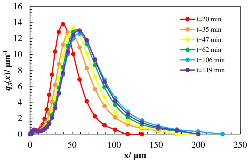
Slika 19. Funkcije gustoće raspodjele kristala tijekom sonokristalizacije pri brzini hlađenja matične otopine od  $8 \text{ } ^\circ\text{C h}^{-1}$  ( $N_{JS} = 324 \text{ o min}^{-1}$ ,  $A = 20 \%$ ,  $T_z = 30 \text{ } ^\circ\text{C}$ ).
