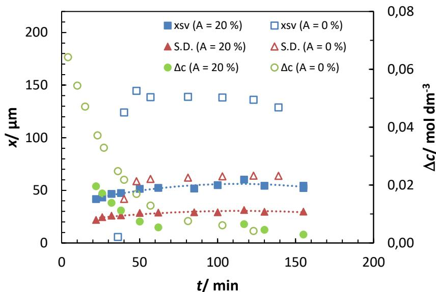
*Slika 28.* Usporedba srednjeg volumnog promjera, standardne devijacije te absolutne prezasićenosti matične otopine pri brzini hlađenja od  $6\text{ }^{\circ}\text{C h}^{-1}$  u sustavima sa i bez ultrazvučnog djelovanja ( $N_{JS} = 324\text{ o min}^{-1}$ ,  $T_z = 30\text{ }^{\circ}\text{C}$ ).
