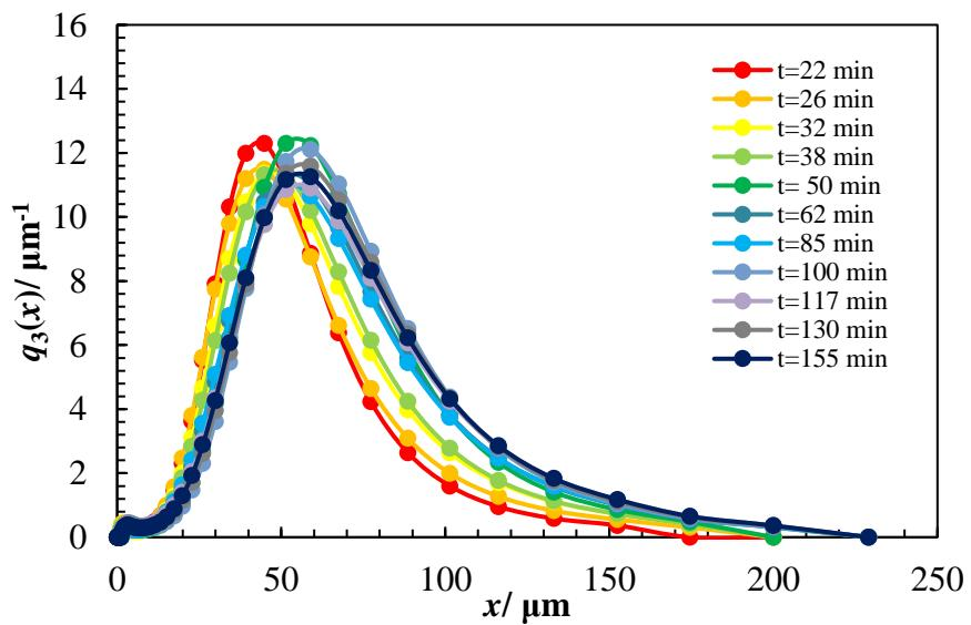
Slika 18. Funkcije gustoće raspodjele kristala tijekom sonokristalizacije pri brzini hlađenja matične otopine od  $6 \text{ } ^\circ\text{C h}^{-1}$  ( $N_{JS} = 324 \text{ o min}^{-1}$ ,  $A = 20 \%$ ,  $T_z = 30 \text{ } ^\circ\text{C}$ ).
