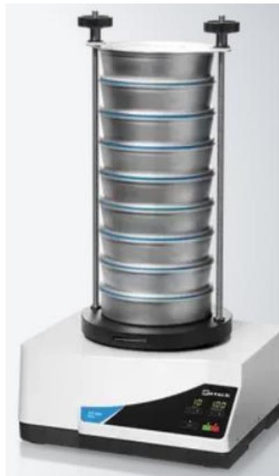
*Slika 15.* Tresilica tipa *Retsch AS 200*.
