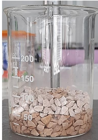
Slika 12. Određivanje poroznosti metodom zasićenja.
