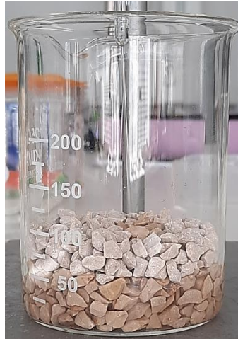
Slika 12. Određivanje poroznosti metodom zasićenja.
