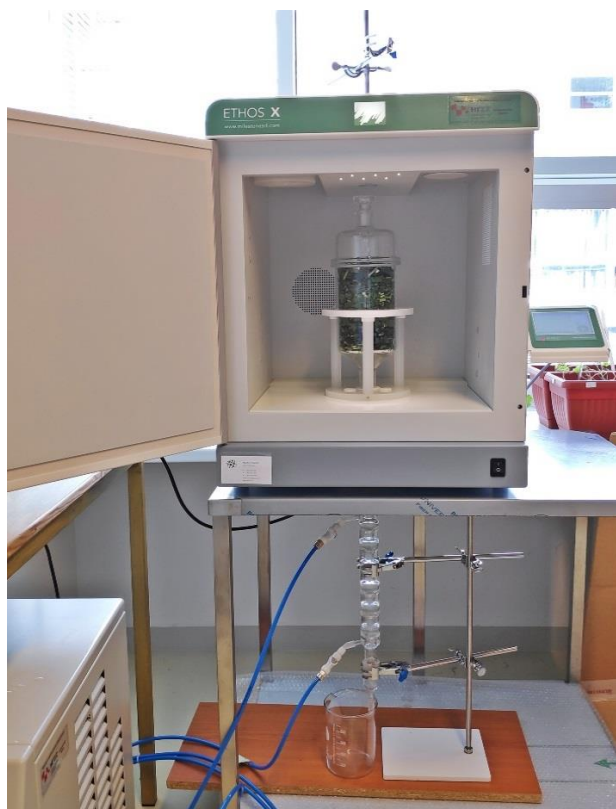
Slika 3.3.2.2.1. Uređaj za mikrovalnu ekstrakciju.
