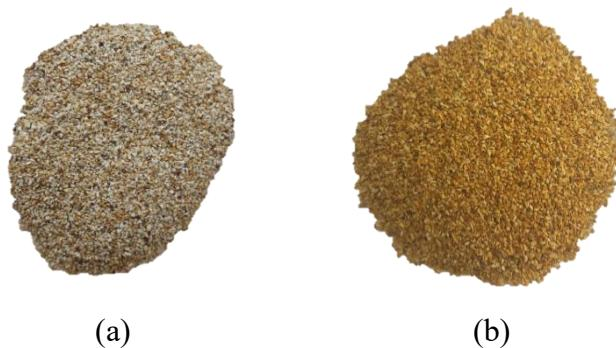
Slika 2.1. Usporedba (a) prirodnog i (b) Fe(III)-modificiranog zeolita.
